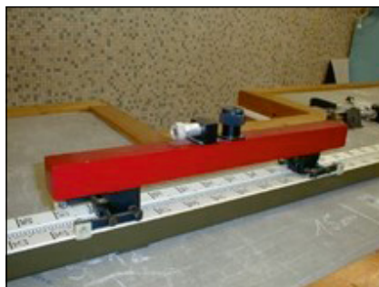
1. ábra. Az MTA GGKI és a MOM kooperációjában készült hordozható terepi léckomparátor
