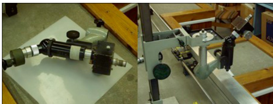
4. ábra. Koincidenciás mérőmikroszkóp
