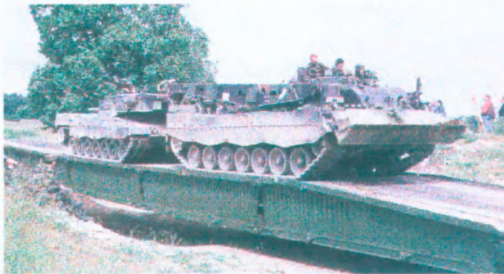
7. ábra: A DoFB híd maximális terhelés alatt
