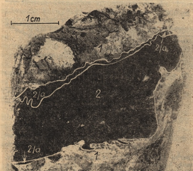
3. ábra. A Bódvalenke 1. sz. fúrás maganyaga 27 m-ből. (A kőzetanyag a száraz magfúrás következtében összenyomódott, meggyűrődött.) Magyarázat: 1. Homokos, kőzetlisztes, kaolinites agyag, 2. Hematit, apró vascsillámpikkelyek halmaza, 2/a. Limonitos (vasokkeres) kéreg.
