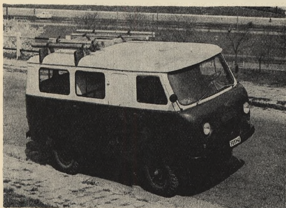
4/a ábra: A K-500-2 típusú spektrumfrekvenciás karottázs berendezés
