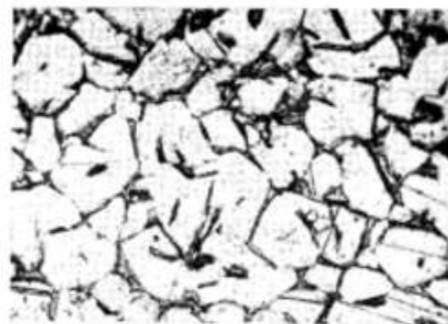
3. ábra. \alpha + \beta kristálystruktúrájú 58/42 sárgaréz 130 °C
