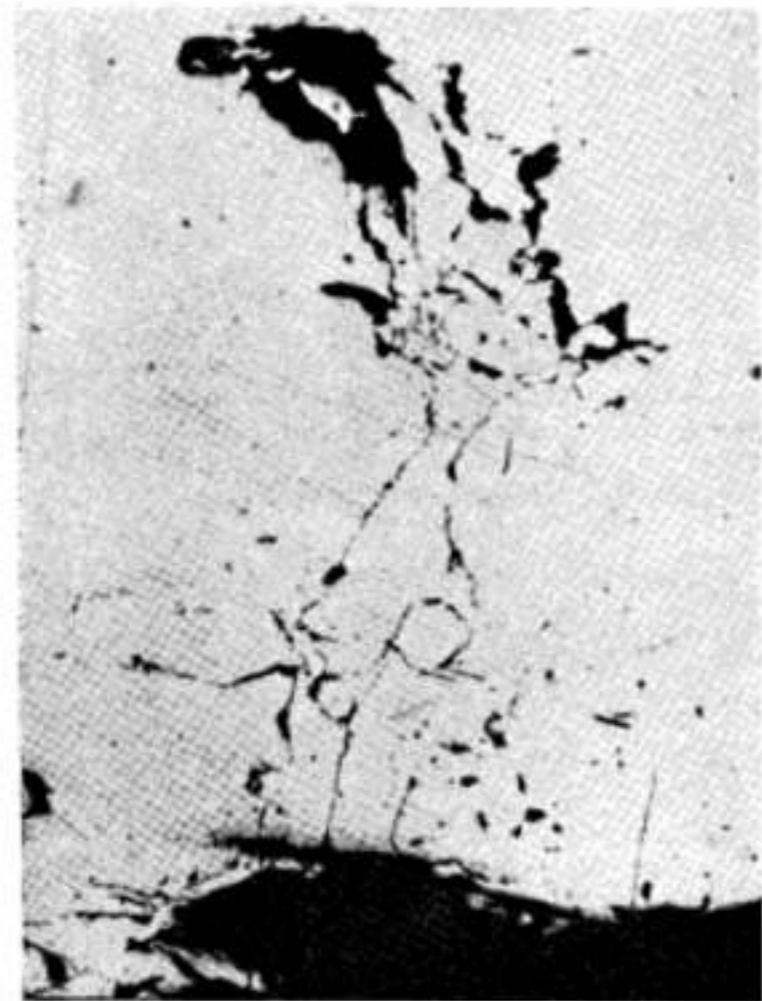
8. ábra. A felszíni védőréteg alatt erős korrózió és cinktelenedési folyamat kifejlődése 139 x
