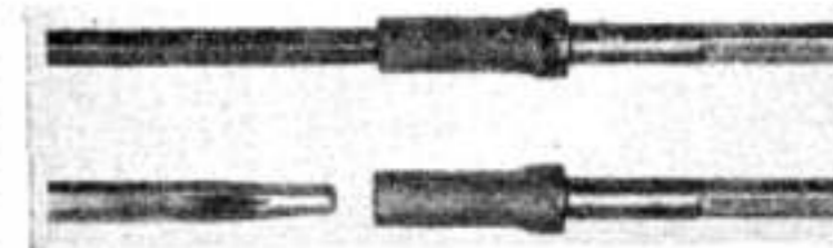
7. ábra. A fúrórud kúpos kapcsolású toklása.
