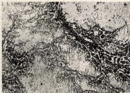
13. kép. II. maratás után gyengén fényesítve. 100× Mesterségesen előidézett Cu-tartalmú erek kezdődő repedéssel.
