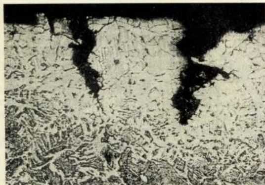
6. kép. Túlhevített szövet, szélén repedésekkel.
