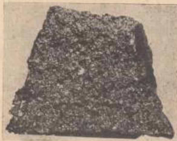
7. ábra. 911. sz. kokillatöret. C = 3.51%, Grafit : 2.98%, Si : 1.47%, Mn = 0.96%, P : 0.14%, S : 0.068%.
