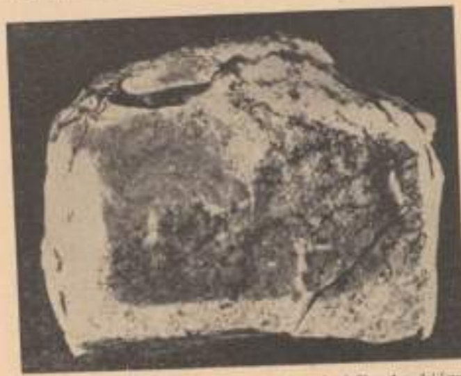
4. ábra. 30×30 mm élhosszúságú mészdarabok kiégetési mélysége (1000°-on 10 percig izzítva).
