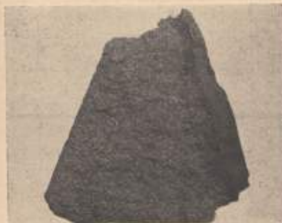
8. ábra. 53. sz. kokillatöret. C : 3.45%, Grafit : 2.94%, Si : 1.48%, Mn : 0.74%, P : 0.12%, S : 0.043%.
