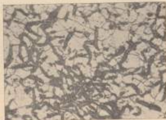
100 X. Szürke öv, temperálva ferrit, temperozán és a grafit helyét.
