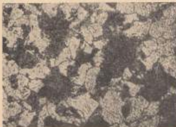
Ferrit temperszénrel és kevés Perlit. 100 X.
