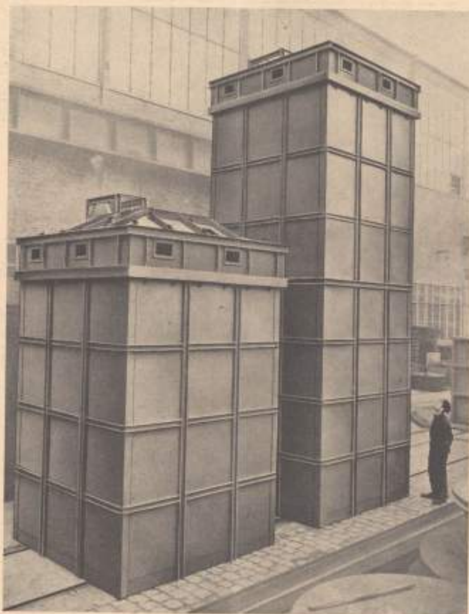
Légkivarósos átnakemencék könnyűfémek nemesítésére 265 és 300 kW
