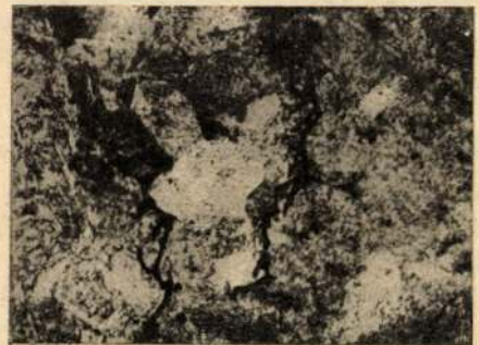
8. ábra. Edzési repedés martensitben; maratás alkoholos sósav-pikrinsav. 1% C.
