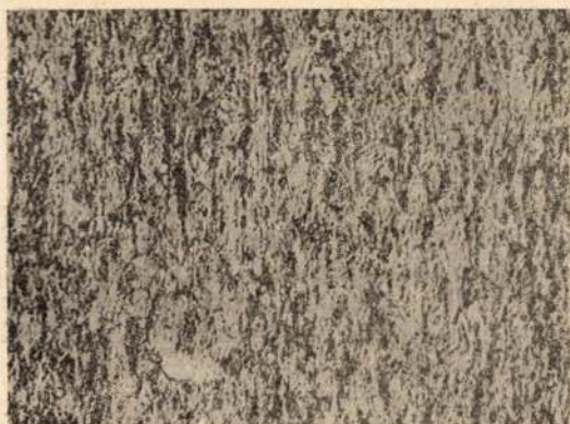
17. ábra. Helyesen hőkezelt drót szerkezetűje. (Nagyítás: 200 \times )
