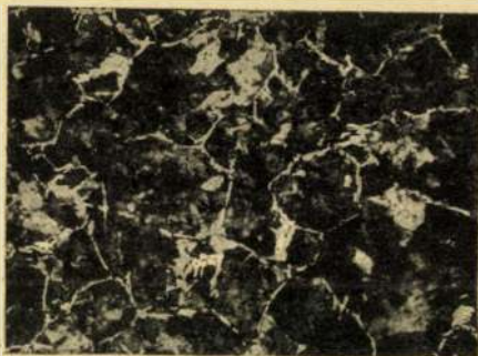
4. ábra. Az austenit szemnagyságát eláruló ferrittháló. 0.47% C.
