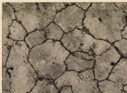
5. ábra. Az austenit szemnagyságát eláruló cementittháló. 1.3% C.
