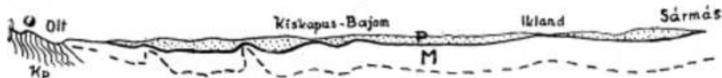
3. rajz. A kiskapusi boltozaton és antiklinákon, észak-déli irányban fektetett szelvény. (Mrazec Jekelius szerint.) P pontusi-pannoniai, M miocén (főként szarmata) Kp kristályos pala alaphozság.
