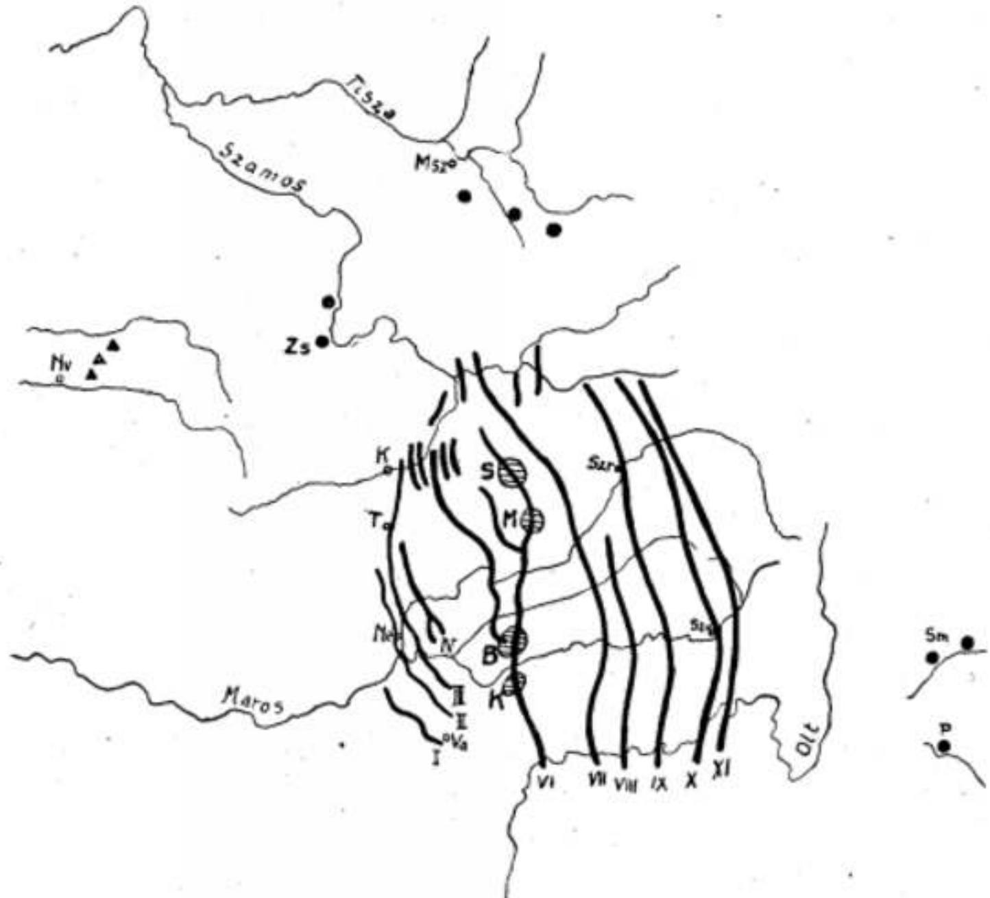
1. rajz. Erdély szénhidrogénjei. (Az I—XI. számozott vastag vonalak az eddig ismert metángáz-vonulatok, a kerekpontok a petróleum, a háromszögek pedig az aszfaltos előfordulásokat jelentik.)
