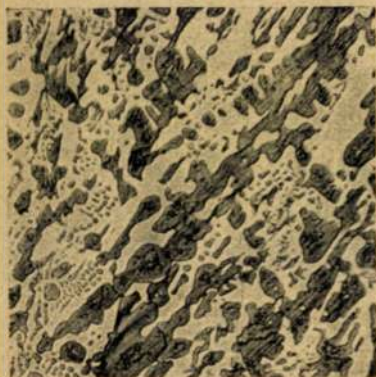
37. kép. C = 3,88% Si = 0,475% Mn = 8,30% 1050°-on 1/2 óráig, beedzve
