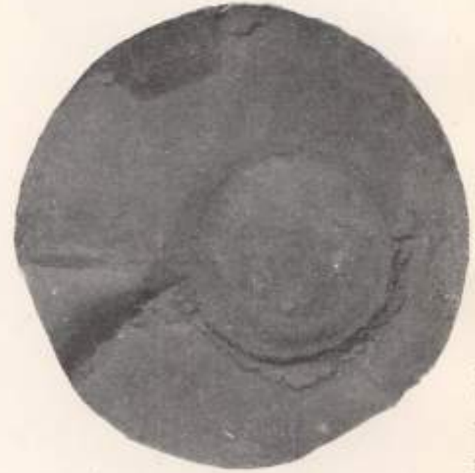
14. ábra. Feczipöntő formapár sárgarézből, gipsz. betétgyűrűvel.
