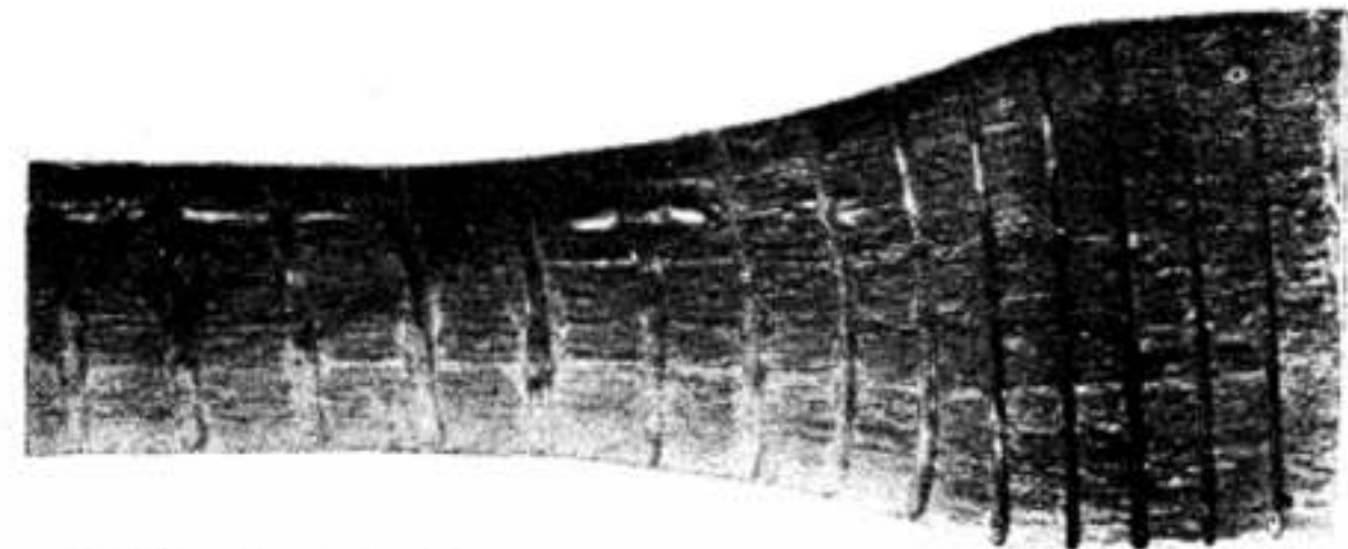
12. ábra. Egy oldalt függőlegesen besztott négyzetes rúd a hengerlés után.
