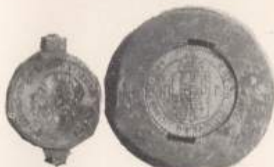
8. ábra. Magyar egyforintos verődűz lemezpárja aczélból.
