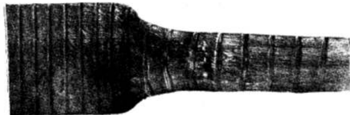
19. ábra. Függőlegesen rovátkolt rúd kovácsolása.
