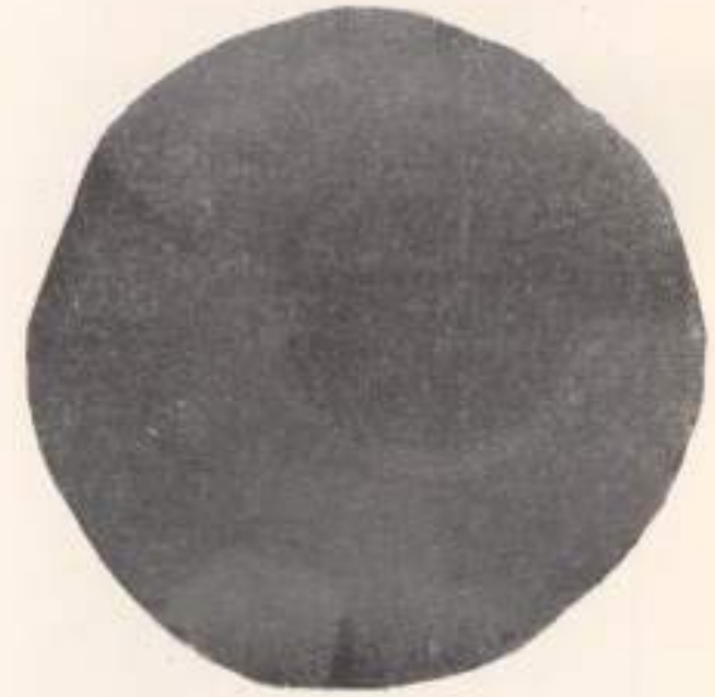
15. ábra. Hamis feczipöntő formapár gipszből, már öntésre egyszer felhasználva.
