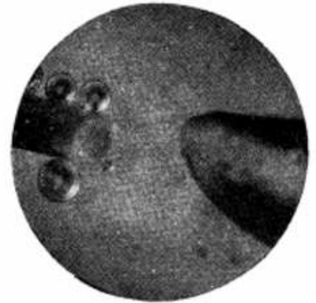
17. kép. Antimon elektromos ejtése szulfursójából 110-szeres nagyításnál.
