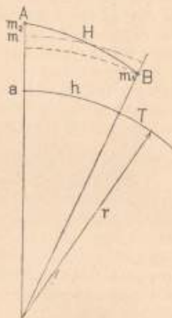
24. ábra. Az alapvonalnak a földsgárra való vetítése.
