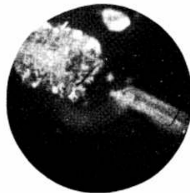
19. kép. Bizmut kiválása a (-) elektródán szulfatos oldatából, 110-szeres nagyításnál.
