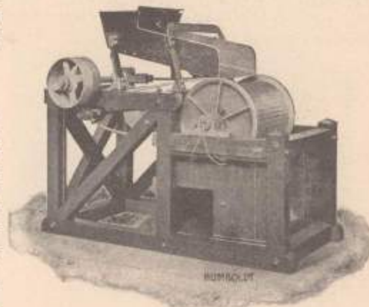
15. ábra. Fémvas kiválogatására szolgáló szeparátor.
