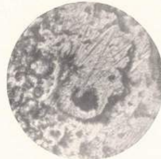
8. ábra. Fernezelyi ezinkes dús hab és kéreg 230 lin. nagyításban.
