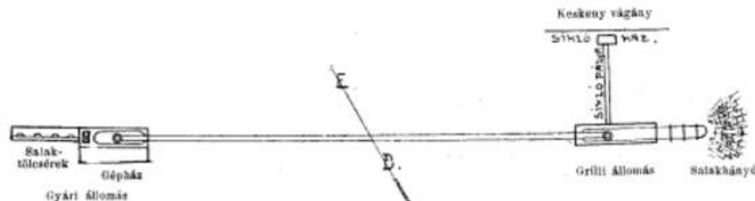
3. ábra. A tiszolci mész- és salakszállító kötélpálya alaprajza.
