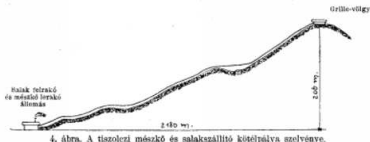
4. ábra. A tiszolczi mészkő és salakszállító kötélpálya szelvénye.
