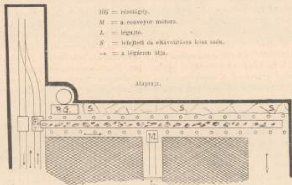
13. ábra. Réselőgép és conveyor egy 90 cm. vastag telepen.
