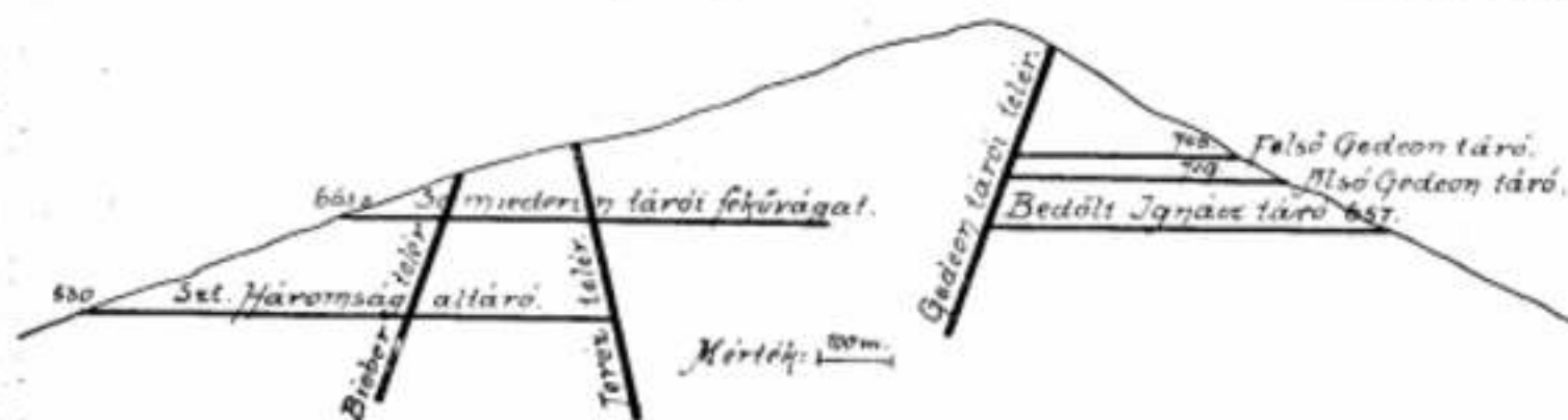
A Gedeon-tárói műveletek szelvénye.
