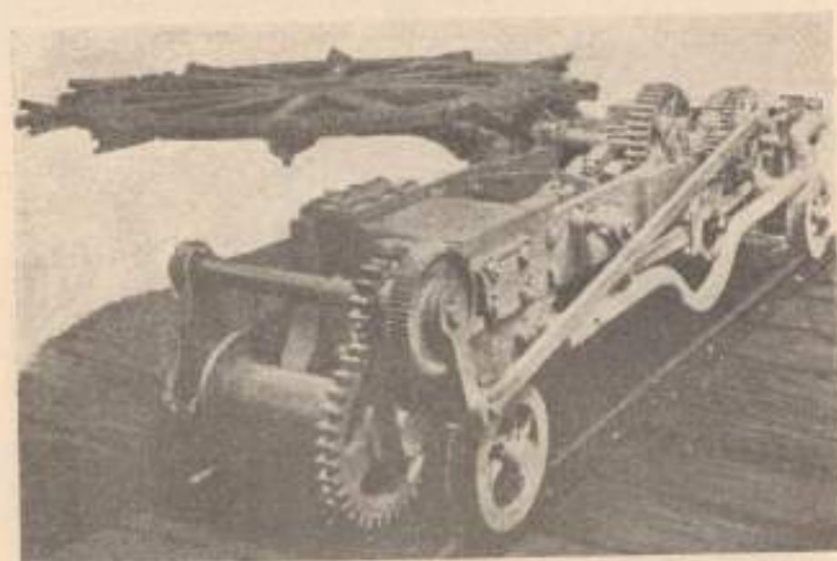
8. ábra. Három fázisú kerékes gép felül szerelt kerékekkel.
