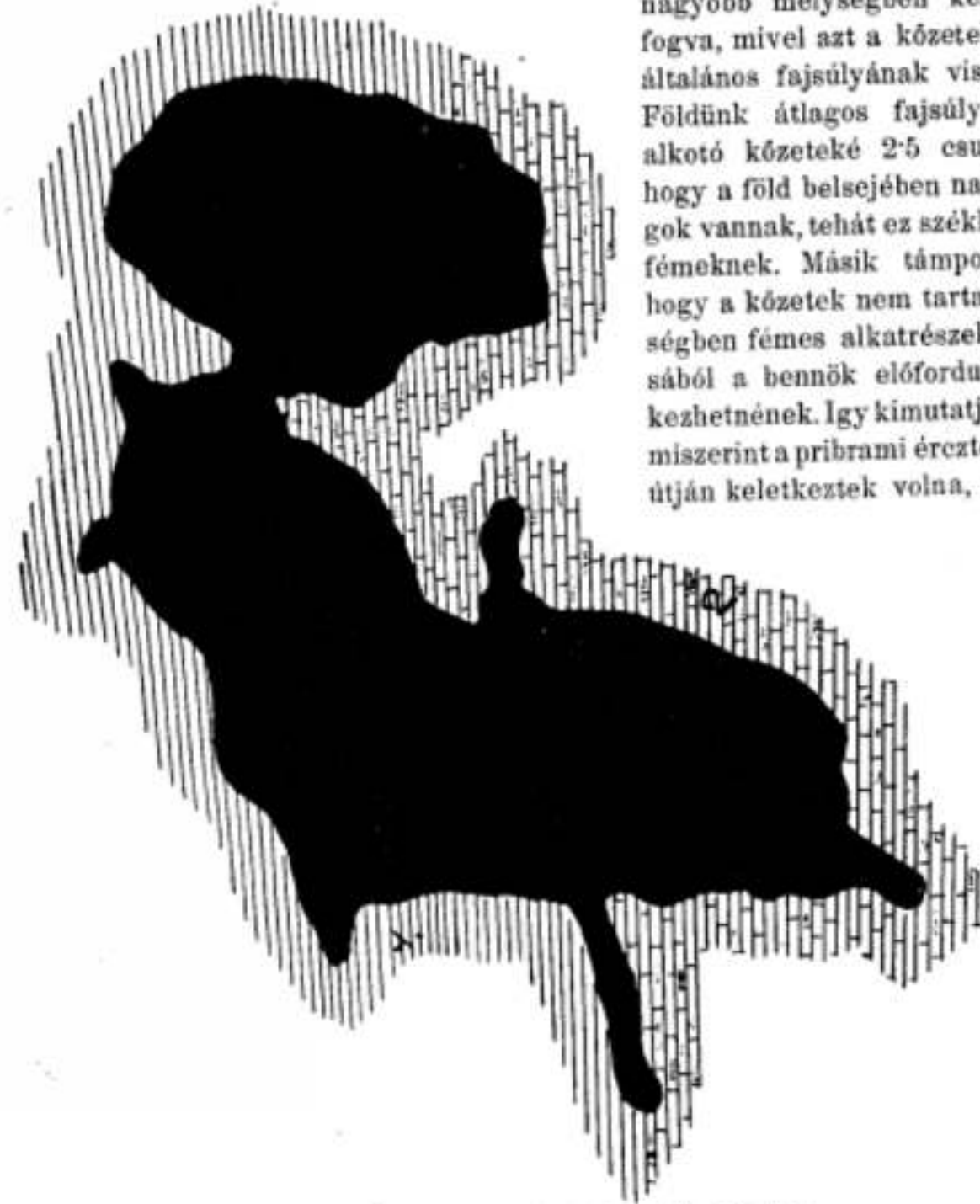
S. ábra. A luchi bánya vasércztelepe (Gesell után). 1. Pala agyag mint fedőkőzet. 2. Főér mész mint telephőzet. 3. Vasakó (fekete).
