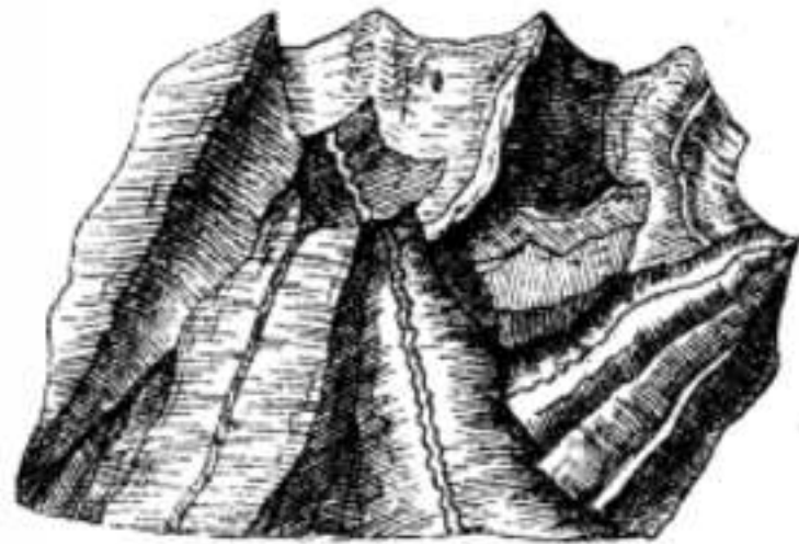
17. ábra. 900/1000 finom ezüst-rézötvözet kristálycsoportja 620-szoros nagyításnál, salétromsavval való etetés után. (Abbé-féle készülékkel lerajzolva).
