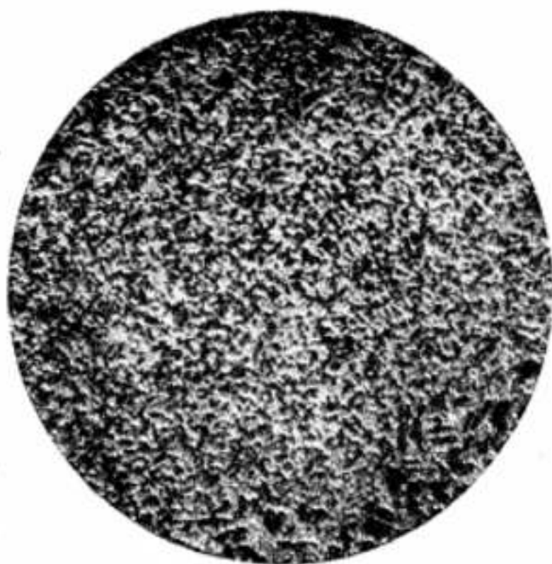
23. ábra. Selmecezi keményíóom 34.28% Sb tartalommal, 71-szeres nagyításnál, HCl-el etetve.
