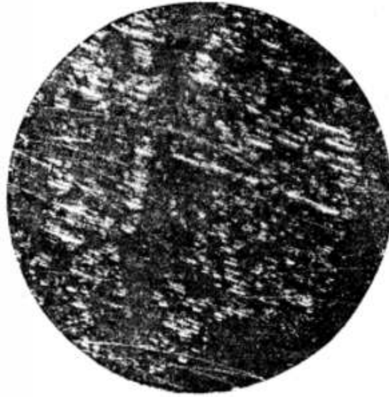
39. ábra. Bányai antimon-regulus, 71-szeres nagyításnál, HNO 3 -al etetve.
