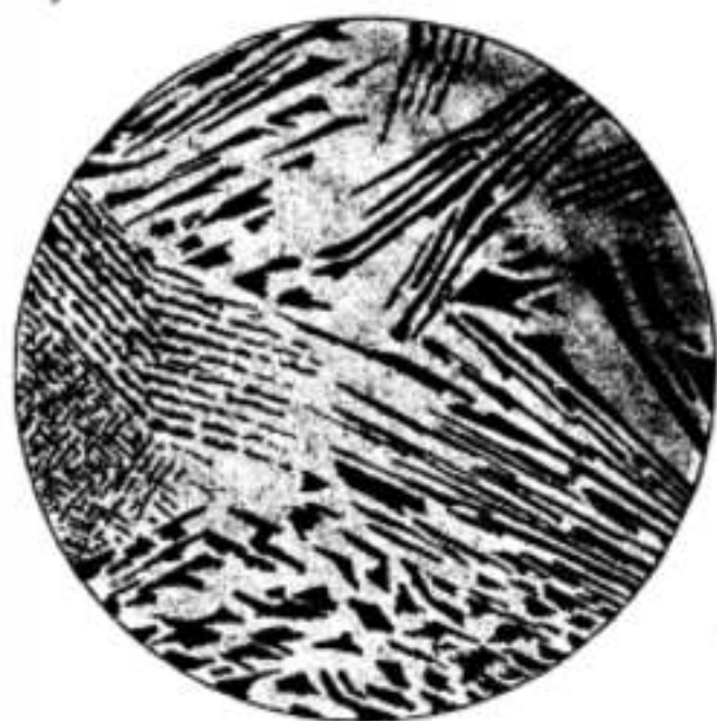
10. ábra. 72% Ag + 28% Cu = eutektikai ötvözet 620-szoros nagyítás mellett, bíborpirosra befuttatva.
