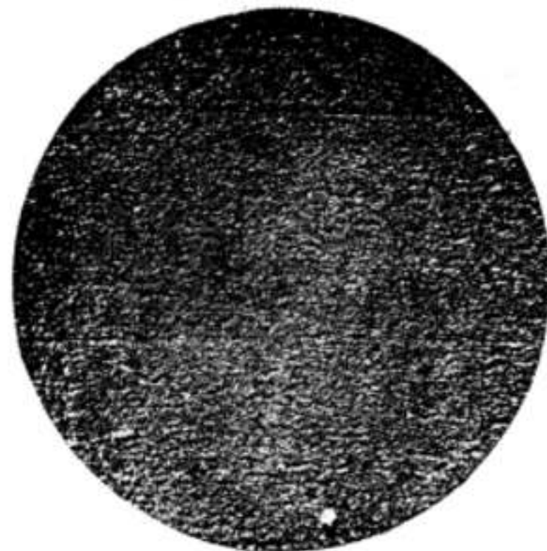
7. ábra. 80\% Cu + 20\% Ag, 50-szeres nagyításnál, bíborpirosra befuttatva.
