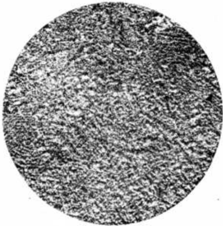
18. ábra. Selmeczi fekete villanó 71-szeres nagyításnál, jodkaliummal etetve.
