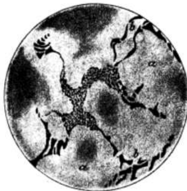
6. ábra. 90\% Ag + 10\% Cu, 620-szoros nagyításnál, bíborpirosra befuttatva.
