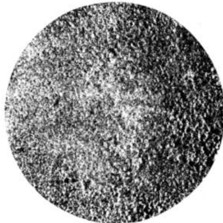
37. ábra. Britannia-fém (81,9% Sn, 16,2 Sb, 1,85% Cu) 71-szeres nagyításnál, HCl-el etelve.
