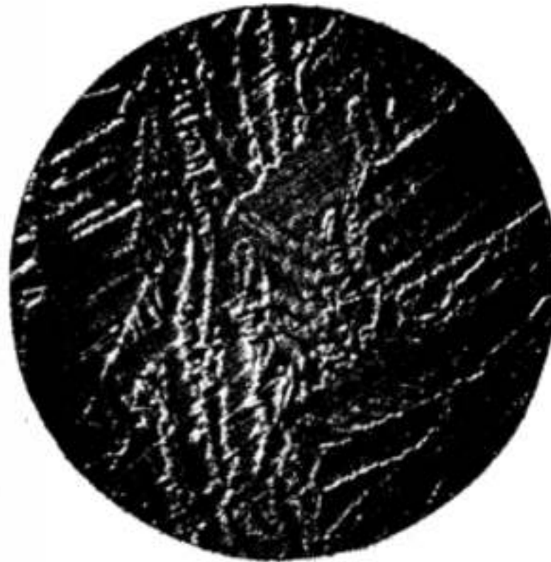
40. ábra. Rézbányai nyers bismuth-fém, 71-szeres nagyításnál, HCl-el etetve.
