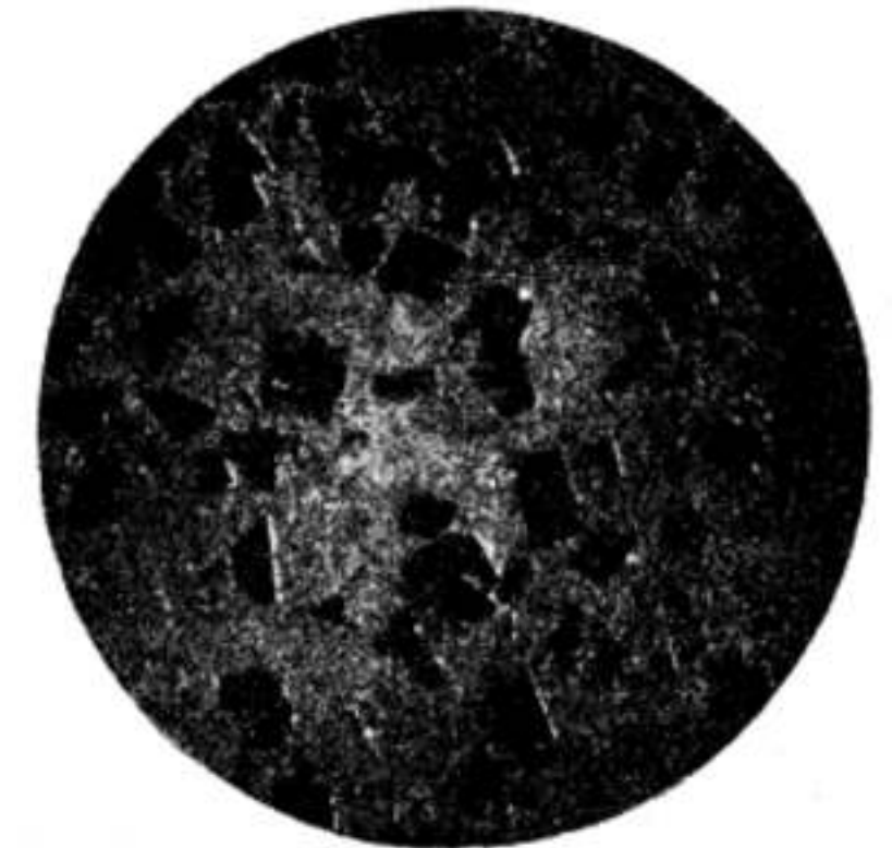
22. ábra. Selmeczi keményólom 19,95% Sb tartalommal, 71-szeres nagyításnál, HCl-el etetve.
