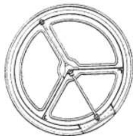
Türk-féle váltószelep alaprajza.
