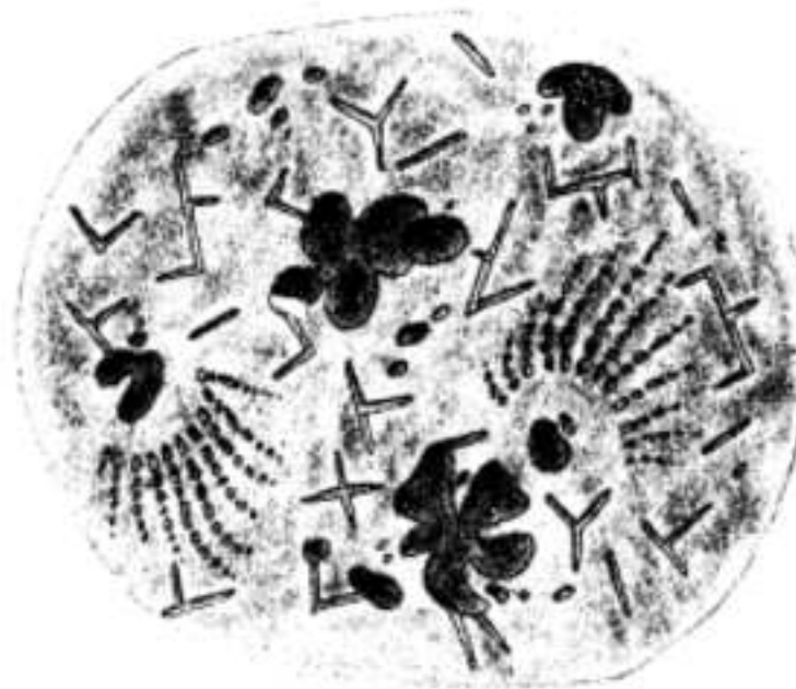
25. ábra. Tajói tárcsaréz 0.415% rondítókkal és 6% Cu 2 O-al 240-szeres nagyításnál, hig HNO 3 és NH 3 -al etetve.
