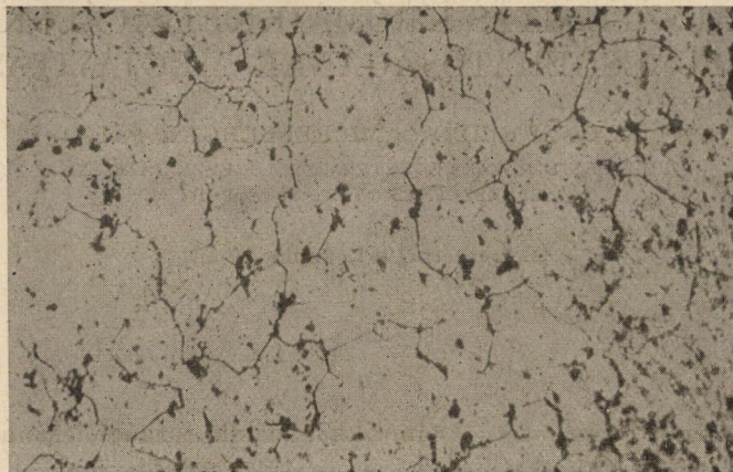
1. ábra. Ausztenites szövetszerkezet. 1100 C°-ról vízben lehűtve, 10%-os oxálsavban elektrolitikusan maratva. Nagyítás 250 ×
