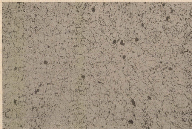
3. ábra. Kiválásos szövetszerkezet kemencében 900-ról 300 C°-ra 12 óráig tartó hűtés után, 10%-os oxálsavban elektrolitikusan maratva. Nagyítás 250 ×
