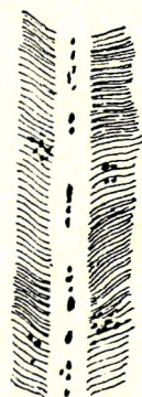
Fig. 73. „Achse“ des Serpentin mit farbloser Hülle; beiderseits liegen die Fasern. Lineare Vergr.: 295.
