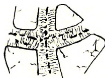
Fig. 76. Zwischen den kleinen Resten von Olivin liegt der faserige Serpentin mit Achsen aus Magnetitkörnchen. Lineare Vergrößerung: 85.
