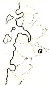
Fig. 47. Zapfenförmige Verlängerungen von Plagioklas (P) gegen Quarz (Q). Lin. Vergr.: 80.
