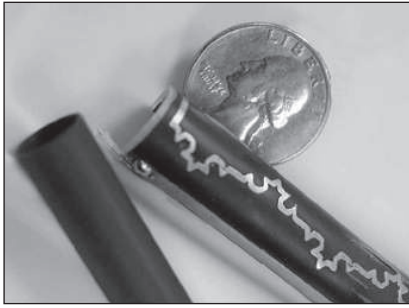
22. ábra. Koch-féle görbét alkalmazó antenna Pólik Zoltán [10] dolgozatának 24. oldaláról
