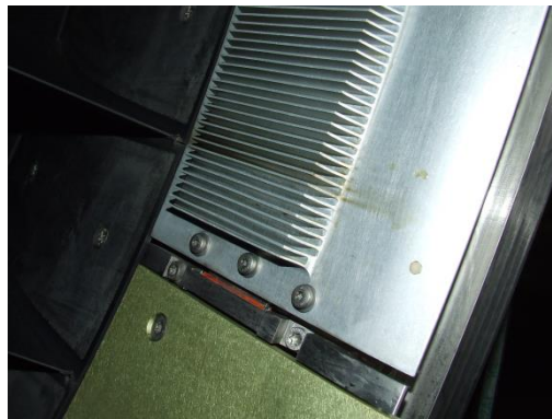
10. ábra Felületi hőcserélő a ventilátor kilépésénél (a szerző felvétele)
