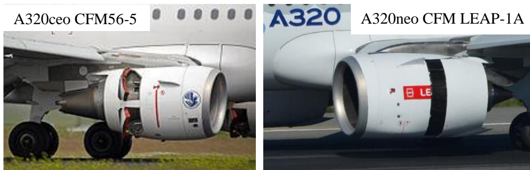
9. ábra Kibillenő ajtós (CFM56-5B) és hátrasikló burkolatos (CFM LEAP-1A) sugárfékek ([20] és [21])
