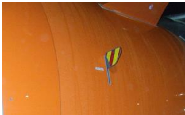
3. ábra CFM LEAP-1A ventilátorburkolat feszítőzárjának nyitott állapotát jelző zászló (a szerző felvétele)
