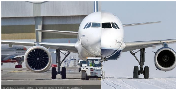
2. ábra CFM LEAP-1A összehasonlítása az A320ceo 10 egyik hajtóműváltozatával (IAE V2500) [9]
