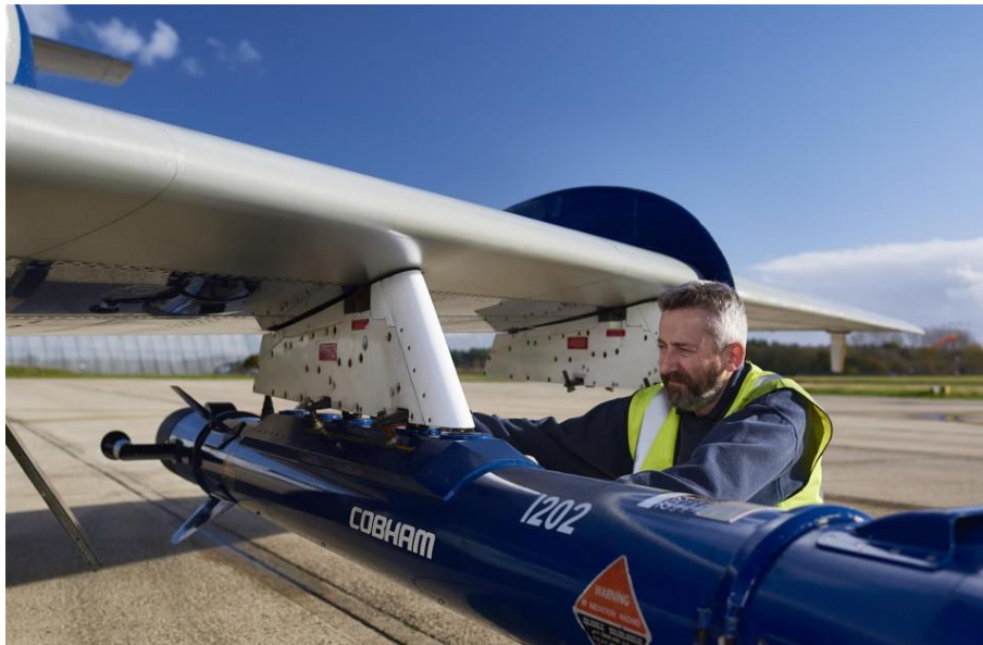
1. kép Zavarókonténer a Dassault Falcon 20 repülőgép szárnya alatt [30]
