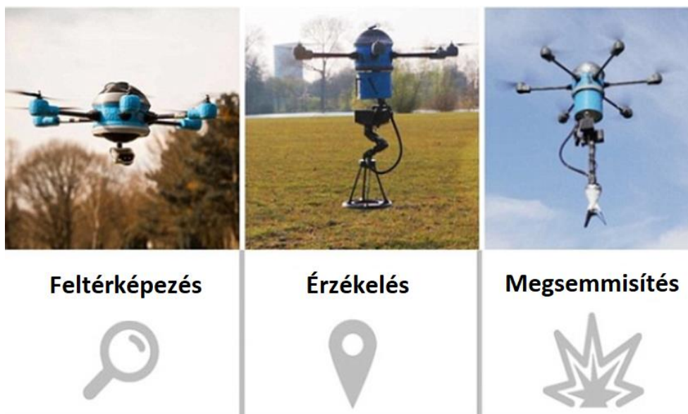
9. ábra Aknamentesítés emberi áldozat nélkül drónokkal [7]
