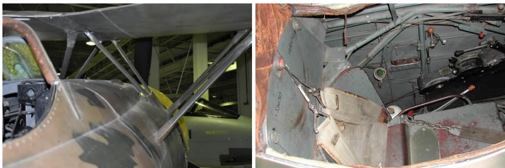
9. ábra A repülőgép pilótafülkéje egyszerű és ergonómikus. Az ülés magassága állítható. A jobb oldali felvételen a Svéd Királyi Légierő gyűjteményében megmaradt repülőgép kabinja látható
