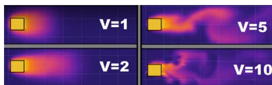
9. ábra A turbulencia kialakulása a sebesség függvényében 17 [24]
