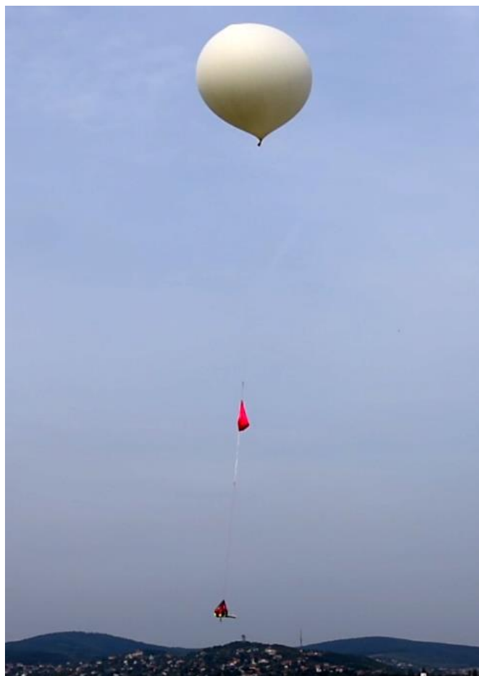
2. ábra Egy könnyű személyzet nélküli szabad ballon [4]
