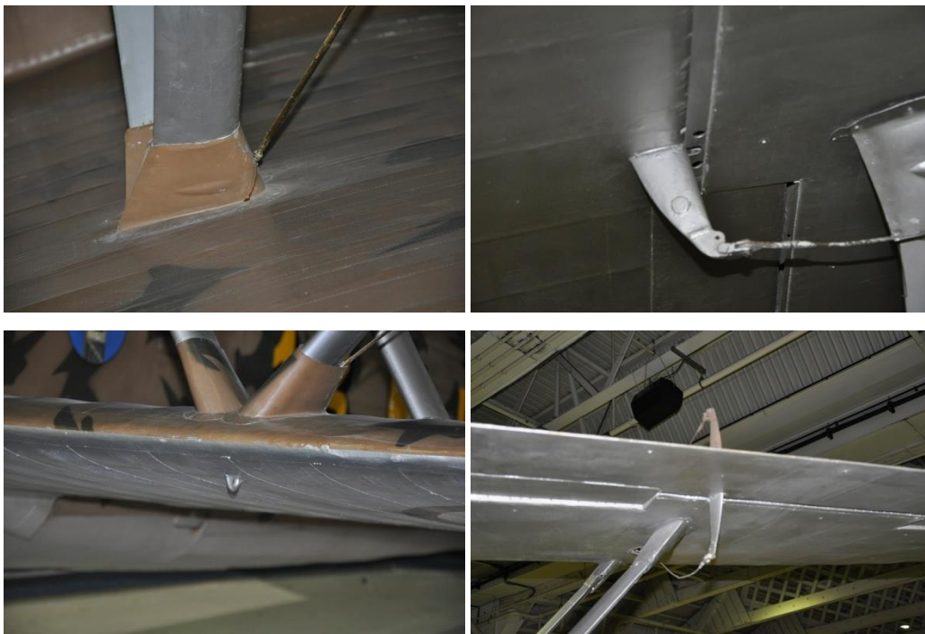
6. ábra A Fiat CR.42-es aerodinamikailag igényesen megtervezett részletei
