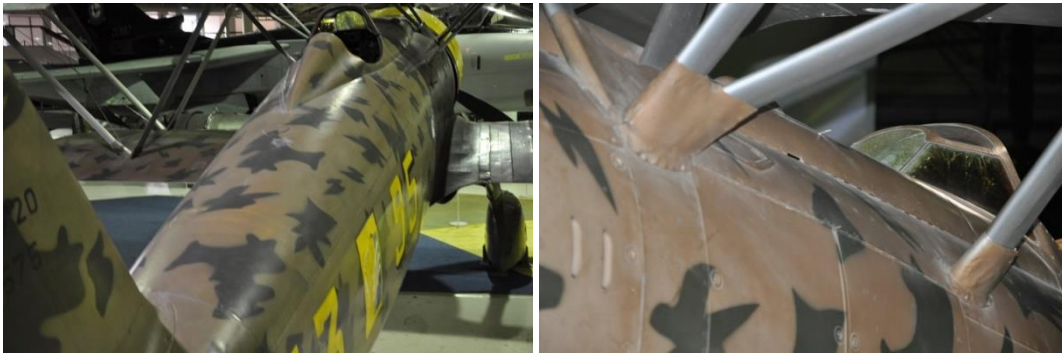
7. ábra A kabin kialakítása során törekedtek rá, hogy a nyitott építés ellenére a pilótát a lehető legjobban védjék az időjárás viszontagságaitól
