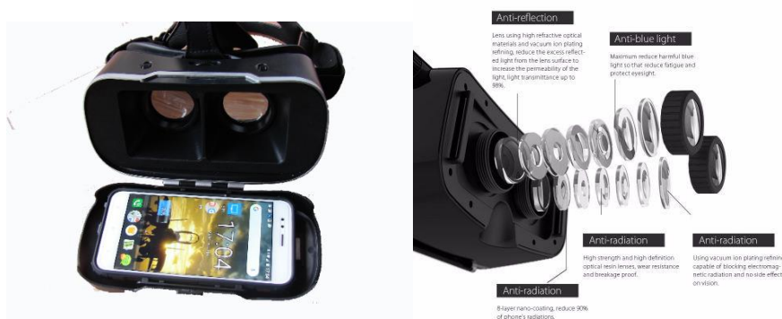
3. ábra A Blitzwolf VR3 részei és a mobilkészíték elhelyezkedése
