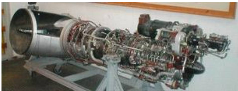
9. ábra Izotov TV2-117A, az első szovjet, helikopterbe tervezett hajtómű (saját kép)
