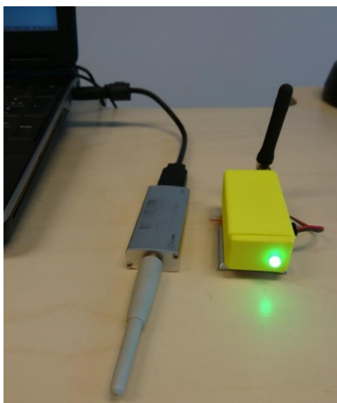
2. ábra Az „InfoPark” szoftveres vevő (balra) és a „PETRA-D” tracker (jobbra), a képet készítették a szerzők
