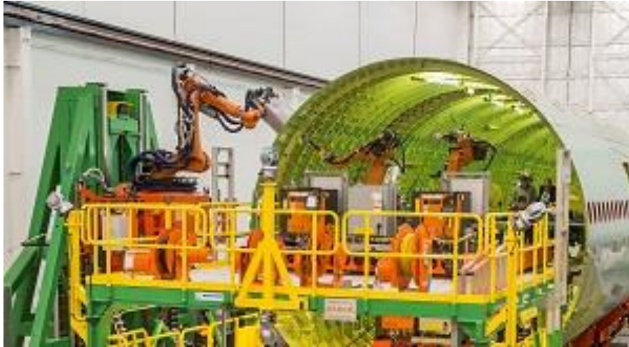
17. ábra KUKA robotok alkalmazása a Boeing 777 törzs szegecselésében [44]
