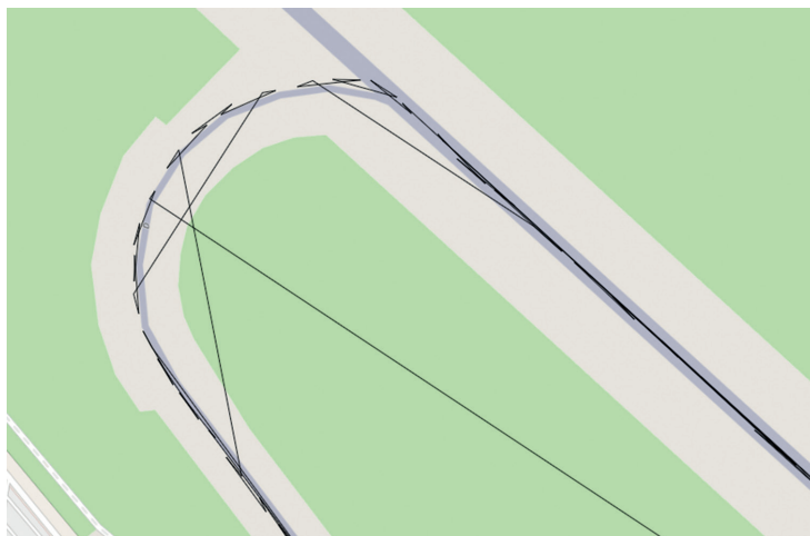
3. ábra Hibás radarjel sorrendezés [a szerző]
