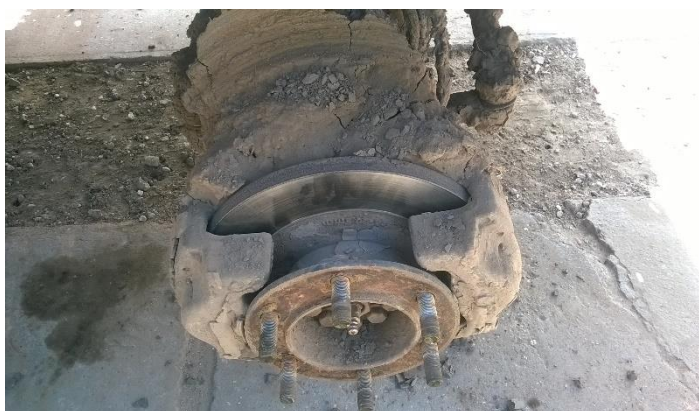
7. számú ábra. MB UNIMOG 4000 katonai terepjáró tehergépjármű jobb első lengőkarának és fékszerkezetének szennyeződése (Bácsalmás)
