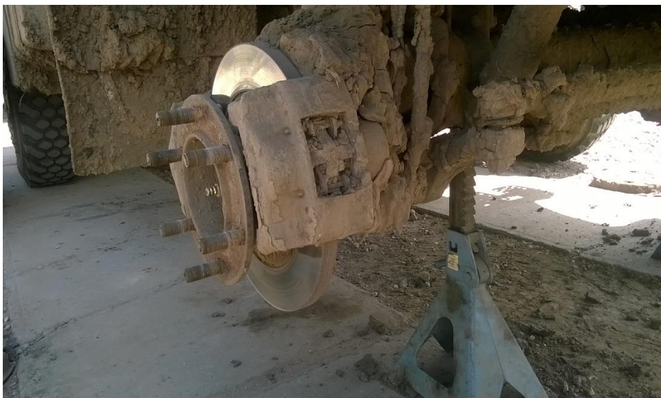
10. számú ábra. MB UNIMOG 4000 katonai terepjáró tehergépjármű jobb első lengőkarának és fékszerkezetének szennyeződése (Bácsalmás)
