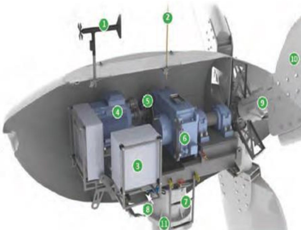
3. számú ábra. 50 kW teljesítményű szélgenerátor gondolójának felépítése 25
