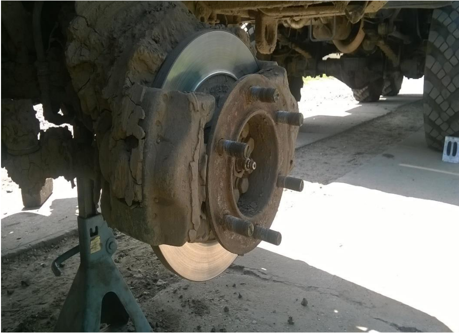
8. számú ábra. MB UNIMOG 4000 katonai terepjáró tehergépjármű bal lengőkarának és fékszerkezetének szennyeződése (Bácsalmás)
