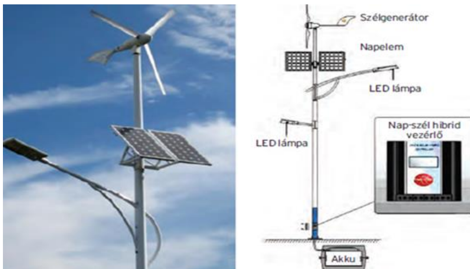
5. számú ábra. Szél- és napenergiás, hibrid, hálózathoz nem csatlakozó megvilágítás. 55
