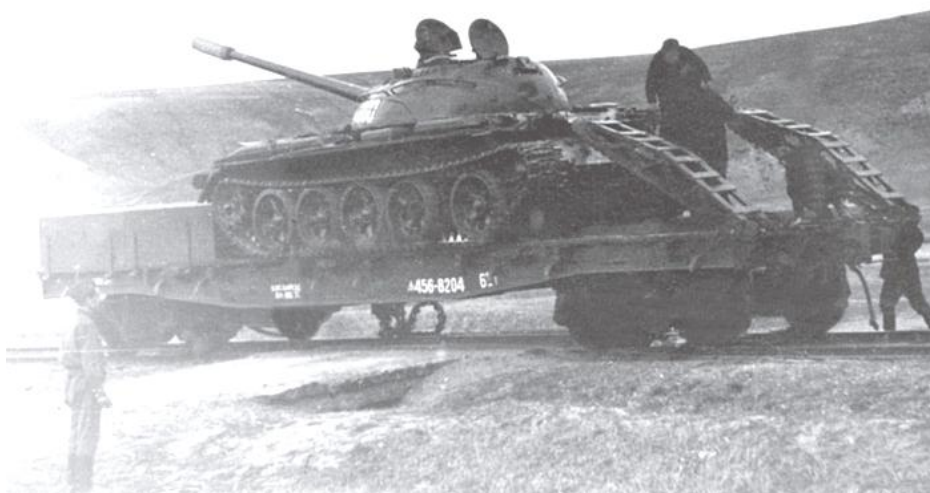
30. ábra. Modern páncélvonat lövegkocsija T-55-ös tankkal és védelmi kazamatával
