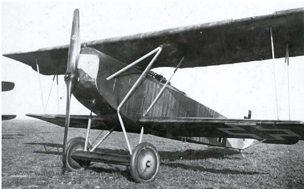
3. ábra. Fokker D.VII vadászrepülőgép. A Magyar Általános Gépgyár licenc alapján gyártotta a típust Mátyásföldön
