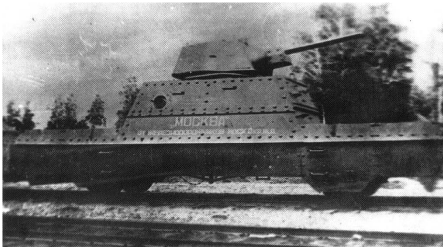
11. ábra. BP-43 típusú páncélvonat egy lövegkocsija T-34-es toronnyal
