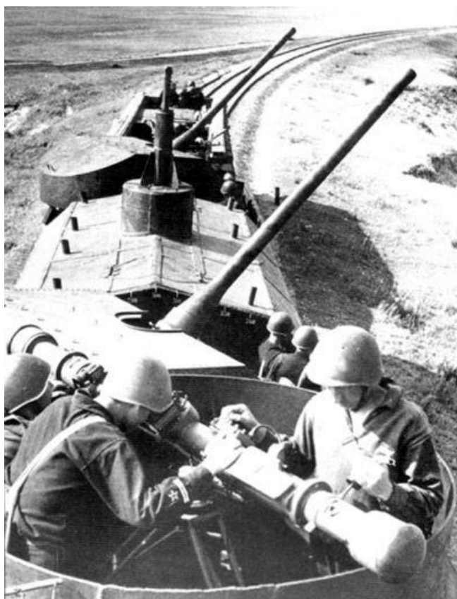
6. ábra. A „За Родину” (A Hazáért) feliratú, 2. számú páncélvonat, tornyában tüzérségi távmérővel
