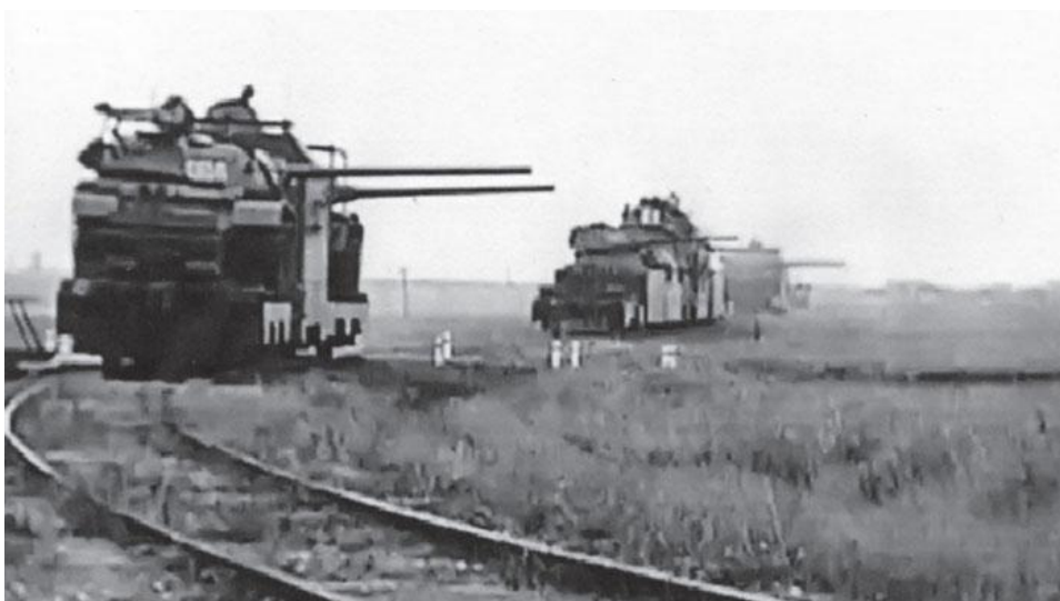
31. ábra. Modulós rendszer szerint összeállított hidegháborús páncélvonatok TGM-14 típusú mozdonyokkal
