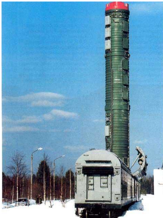
35. ábra. Az indítóegység kiemelt rakétakonténerrel
