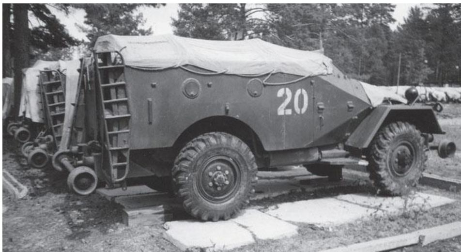
29. ábra. BTR-40 típusú sínautó, amely képes terepen haladásra is
