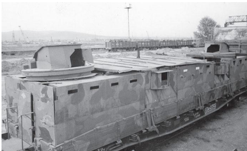
38. ábra. Modern páncélvonat kocsija fegyverzet nélkül
