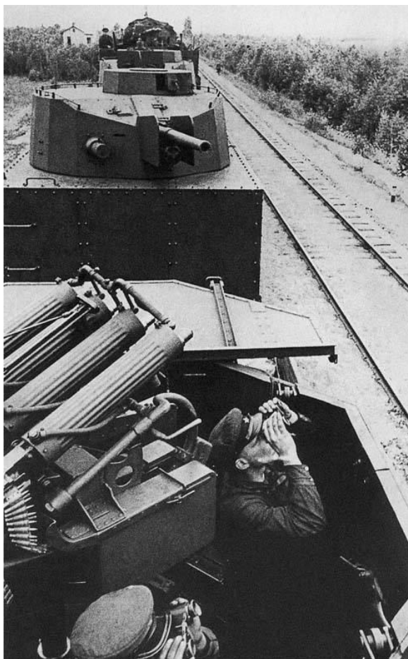
10. ábra. BP-35 típusú vonat légvédelme Maxim géppuskákkal
