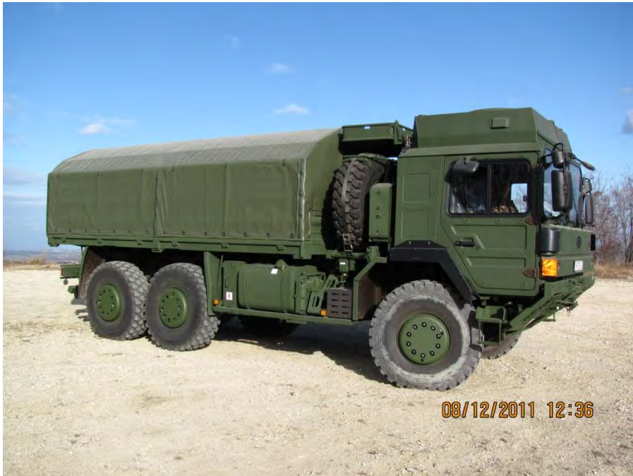
6. ábra. RÁBA H18.240 DAEL-102 7-8 t páncélozásra előkészített fülkésű platós katonai terepjáró tehergépjármű
