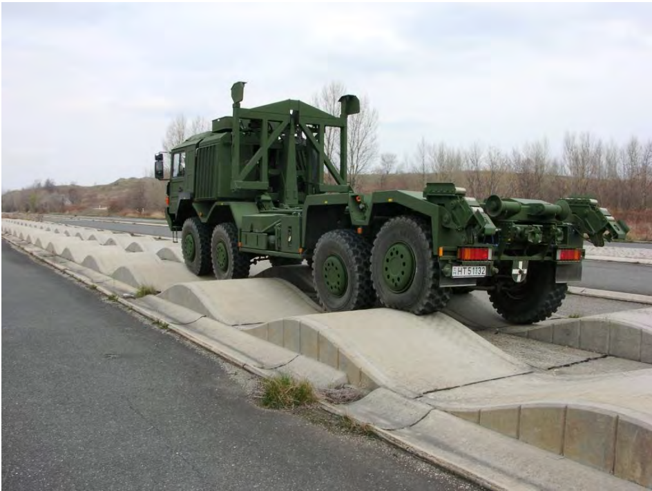
8. ábra. MAN HX32.440 8x8 BB Palfinger T17 hidraulikus horgos emelővel szerelt 20'-as 1CC konténerszállító katonai terepjáró bázisjármű
