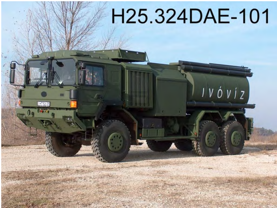
7. ábra. RÁBA H25.324 DAE-101 8 m 3 -es vízszállító katonai terepjáró bázisjármű
