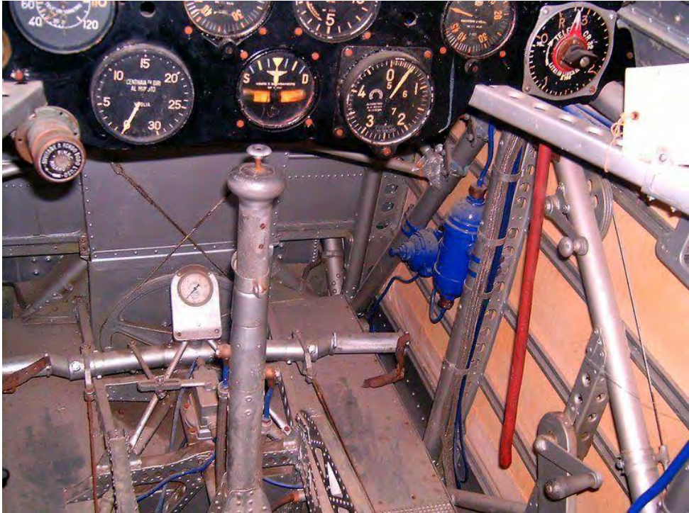
5. ábra. Múzeumi Cr.32 vadászgép pilótafülkéje. A jobboldalon a törzsoldal vásznazásán átűt a vörös vászonfeszítő lakk
