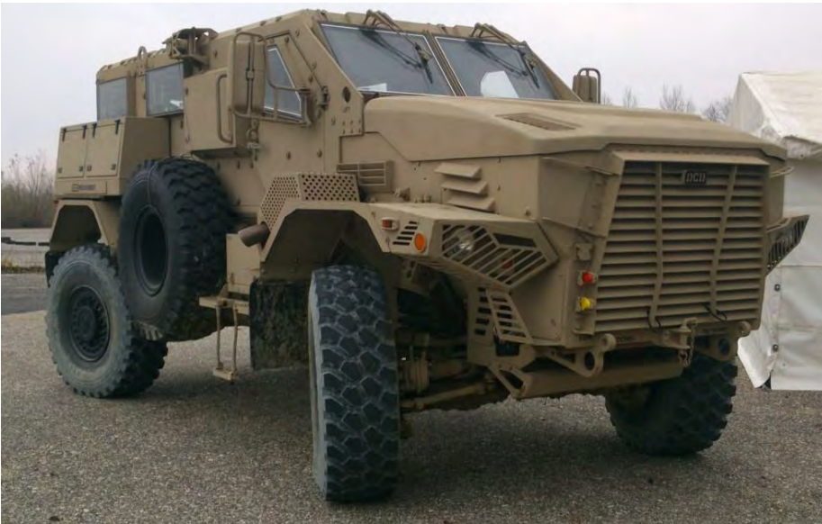
2. ábra. A Mountain Lion jármű a fordulás pillanatában, jól megfigyelhető az összkerékkormányzás
