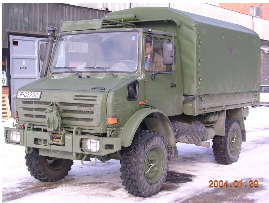
4. ábra. MB UNIMOG 4000 típusú 2 t katonai terepjáró tehergépjármű
