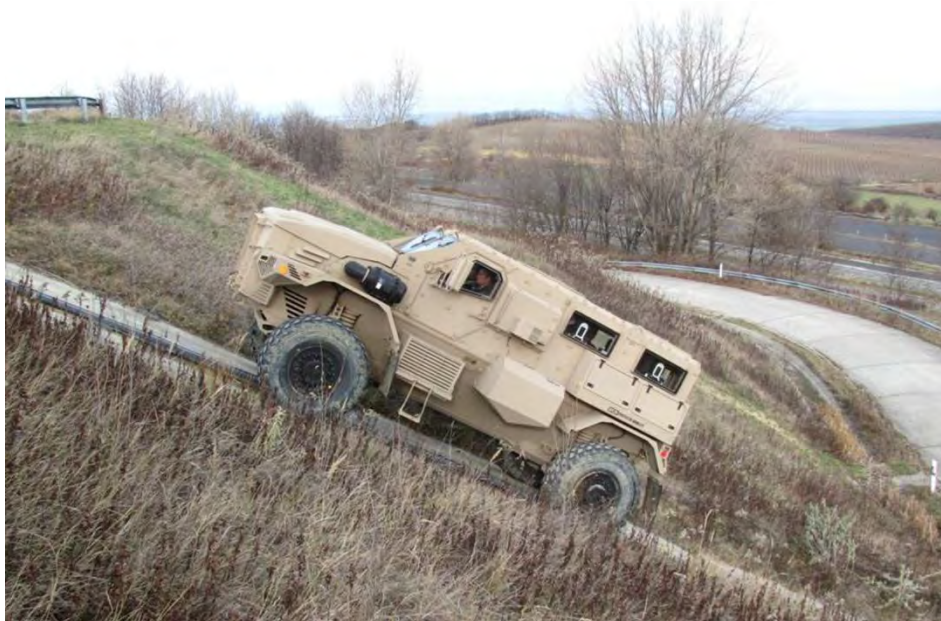
9. ábra. A jármű 30°-os (58%) emelkedőn, betonon
