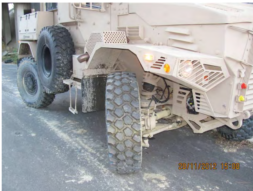
15. ábra. Az összkerék-kormányzású Mountain Lion fordulókör- átmérője mindössze 12,5 m
