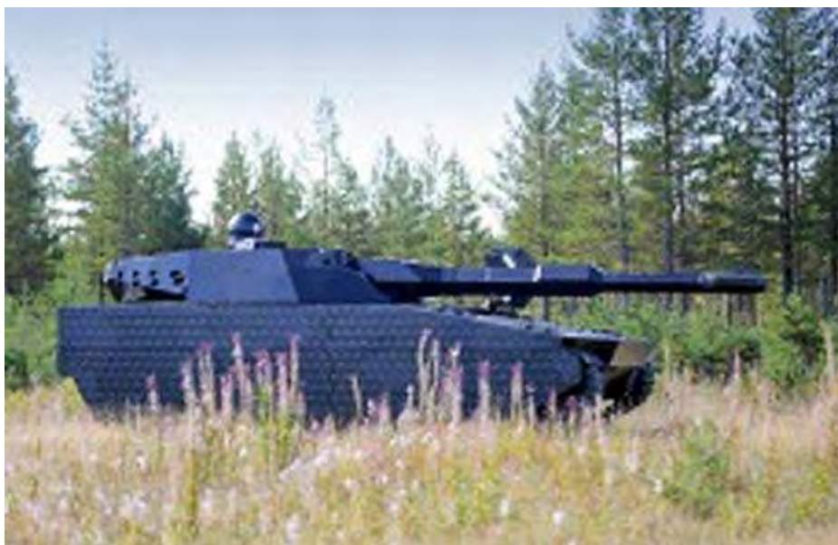
2. ábra. A BAe System cég ADAPTIV típusjelű, Peltier-hőelem modulokból felépülő aktív álcázórendszerének prototípusa egy CV90-120 harckocsira felszerelve
