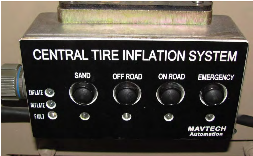
18. ábra. A Központi Abroncsnyomás-Szabályozó Rendszer – CTIS (M. Lion)
