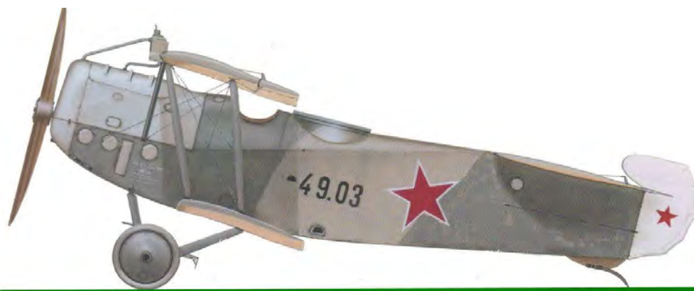
3. ábra. A Tanácsköztársaság 3. századának Phönix C.I típusú felde- rítőgépe Mátyásföldön. A gép a Budapest melletti Aszódon, a Lloyd repülőgépgyárban készült. Ezen a gépen is ugyanazokat a festékeket és rejtőzöszíneket használták, mint a 2. ábra Berg D.I vadászgépén. Magyarország területén üzemelő repülőgépgyárak az akkoriban is- mert legfejlettebb rejtőzőfestési anyagokat és festésmintákat használ- ták
