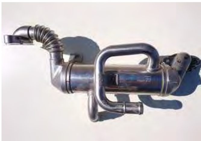
20. ábra. Kipufogógáz-visszavezetés (EGR) hűtője
