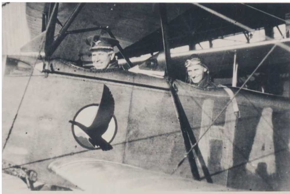
7. ábra. Hungária (az Udet U-12b engedély nélküli kópiája) iskolagép polgári lajstrommal és a Szombathelyi Állami Repülőgépvezető Iskola (REGVI) századjelvényével
