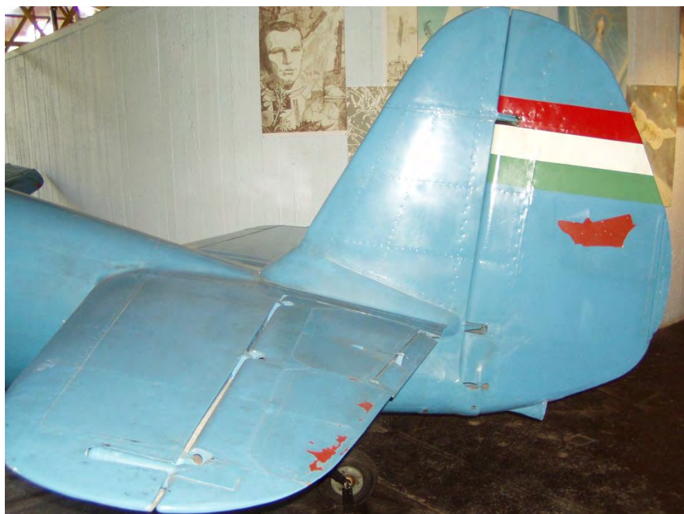
4. ábra. A Közlekedési Múzeum Petőfi csarnokában kiállított Samu-Gönczy SG-2 Kékmadár gépének faszervezetű vásznazott kormányfelületeiről lepattogzott kék festék alól előtűnik a nitróbázisú vörös vászonfeszítő lakk a maga eredeti színében. (a Szerző fotója) A vörös színt nem módosította az eltelt idő, mivel a kék zománc megvédte a fényhatástól. A 20-as, 30-as évek (és a későbbi idők) gépeinek ezüst festése alatt ugyanez a vörös szín volt található. A gép prototípus (sorszám 001), sorozatgyártása esetén a Honvédség rendszeresítette volna SG-2 Rigó néven. A gép eredeti festése piszkos szürkészöld volt, restaurálása során festették kékre, és kapta a Kékmadár nevet
