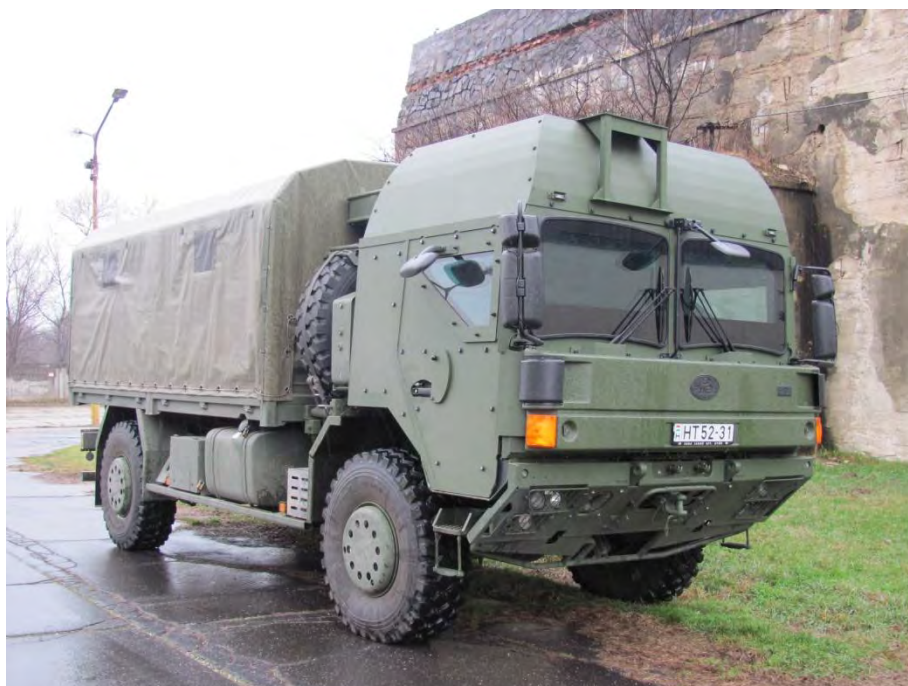
5. ábra. RÁBA H14.240 AEL-103 5-6 t páncélozott fülkésű platós katonai terepjáró tehergépjármű
