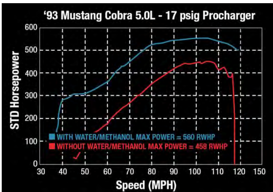
12. ábra. Feltöltéses Otto-motor teljesítménye vízbefecskendezéssel (kék vonal) és vízbefecskendezés nélkül (piros vonal)
