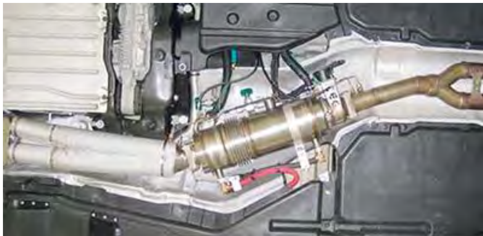
19. ábra. A BMW folyadékhűtésű termogenerátorát a kipufogócső motorhoz legközelebbi közös szakaszára szerelték fel
