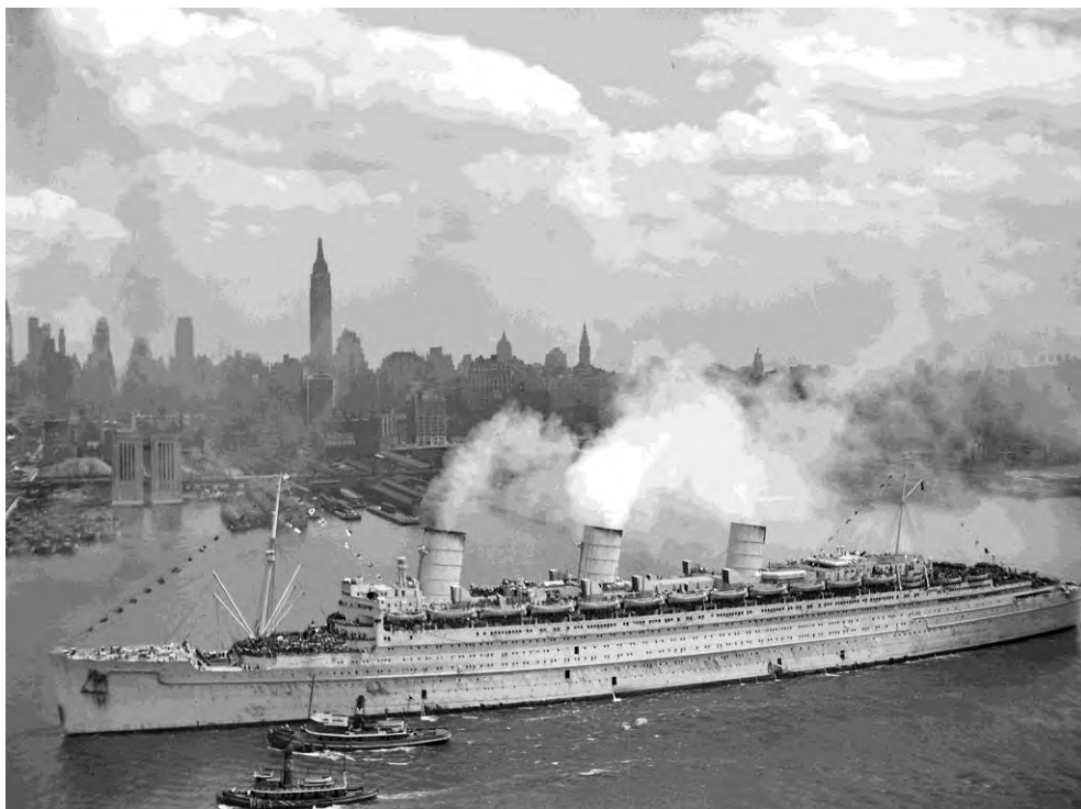
2. ábra. A Queen Mary New York kikötőjében szürke hadifestésben, a mágneses aknák elleni védőberendezéssel felszerelve (a horgony vonalában látható csík a védőberendezés)
