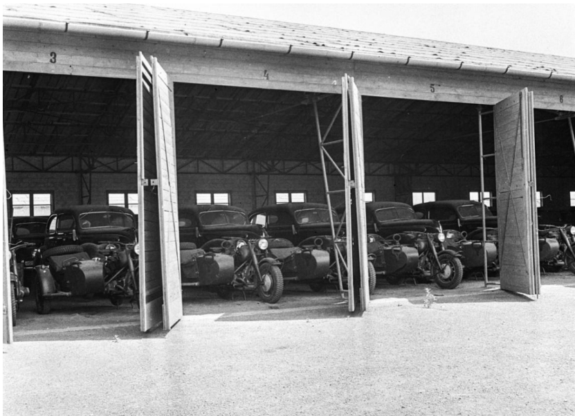
29. ábra. A Gépkocsiszertár könnyű szerkezetű váci gépjárműraktár-épülete nyitott kétszárnyas ajtókkal. Az előtérben a Központi készletben tárolt BMW R75 oldalkocsis motorkerékpárok, mögöttük dán Ford Sedan személyautók (Fortepan 72332 )
