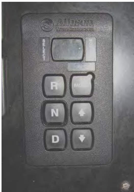
14. ábra. A Mountain Lion automata sebességváltó kezelőpanelje
