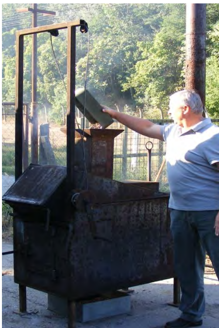
3. kép Lövészlőszer kiégető (pattogtató) berendezés feltöltése
