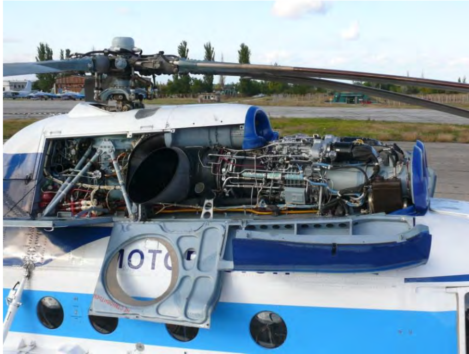
6. ábra. A Mi-8MSzB átépítés közben az új hajtóművével [21]
