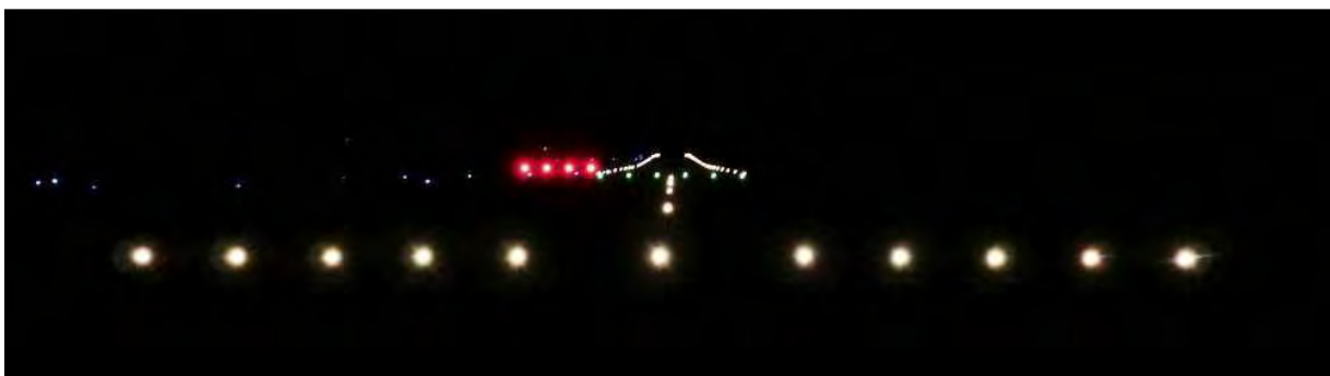
8. számú ábra: PAPI jelzése (siklópálya alatt a gép)
