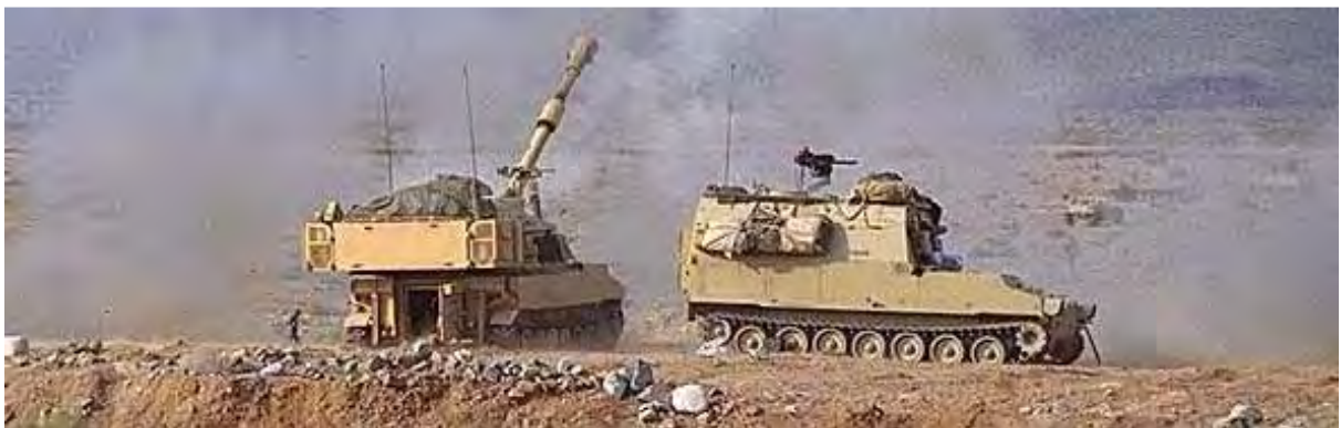
2. ábra. Az M109 alvázán kialakított M992 lőszerszállító kocsin az önjáró löveg mellett
