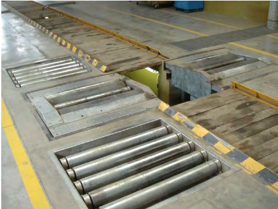
3. számú kép: Görgős fékerőmérő a többtengelyes járművek mérésére alkalmas szabadonfutó görgősorral
