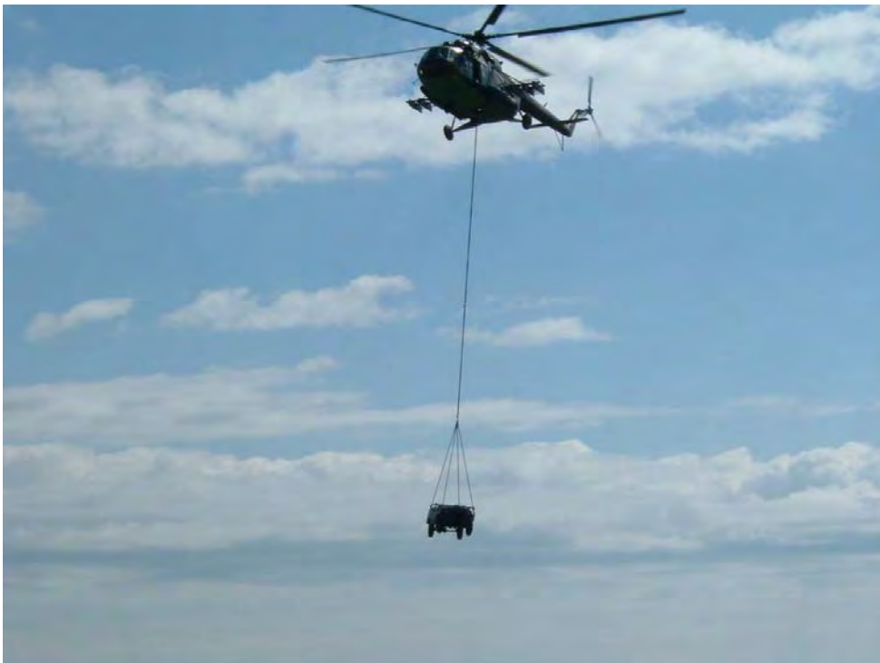
8. ábra. Mi-17 helikopter UAZ terepjáró gépkocsit szállít külső függesztményként
