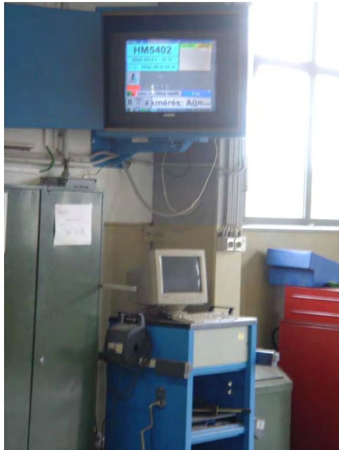
5. számú kép: Másodlagos fékpadi kijelző a központi diagnosztikai eszközöket működtető számítógéppel
