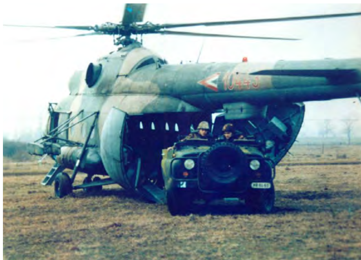
1. ábra. A légimozgékony csapatok támogató fegyverzetének mozgatására alkalmazott könnyű terepjárót deszantolnak egy Mi-8 szállító helikopterből
