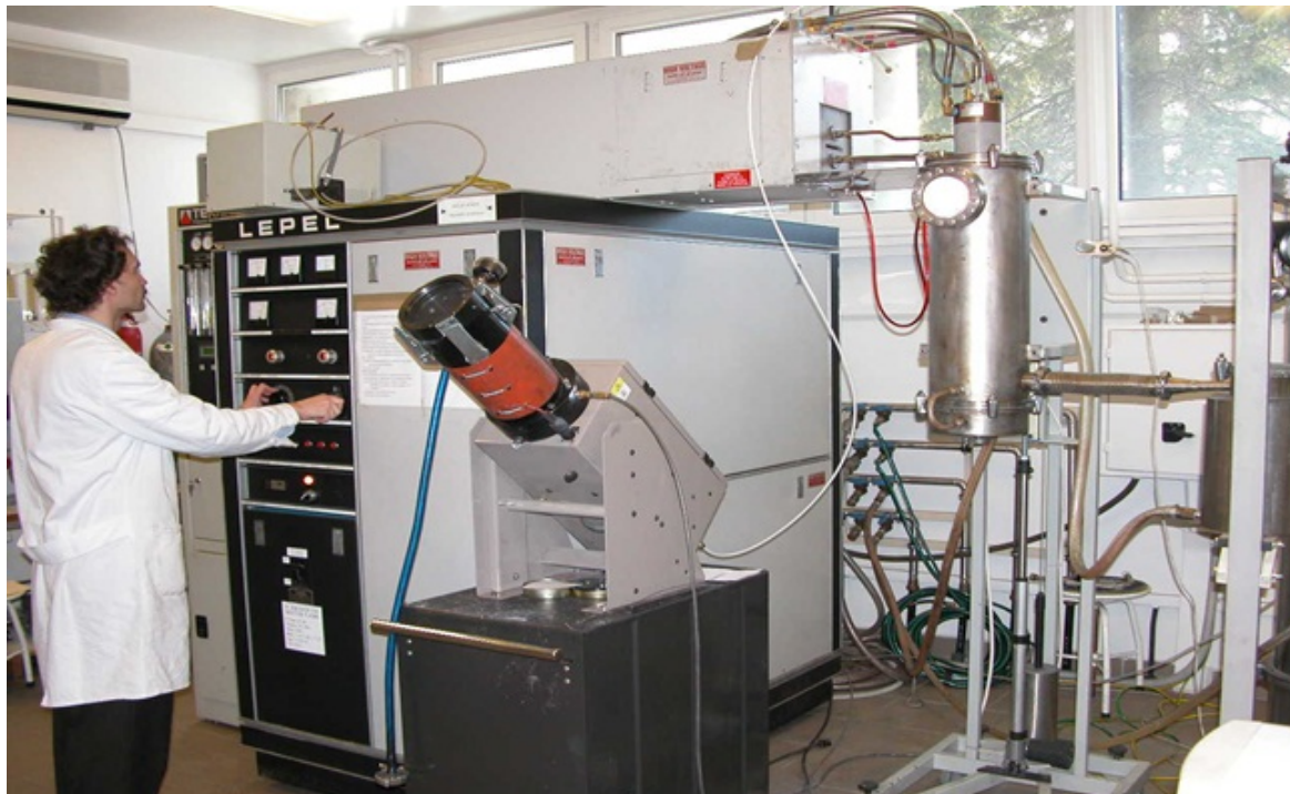
2. ábra. Nanopor előállítás az MTA Kémiai Kutatóközpont Anyag- és Környezetkémiai Intézetének laboratóriumában
