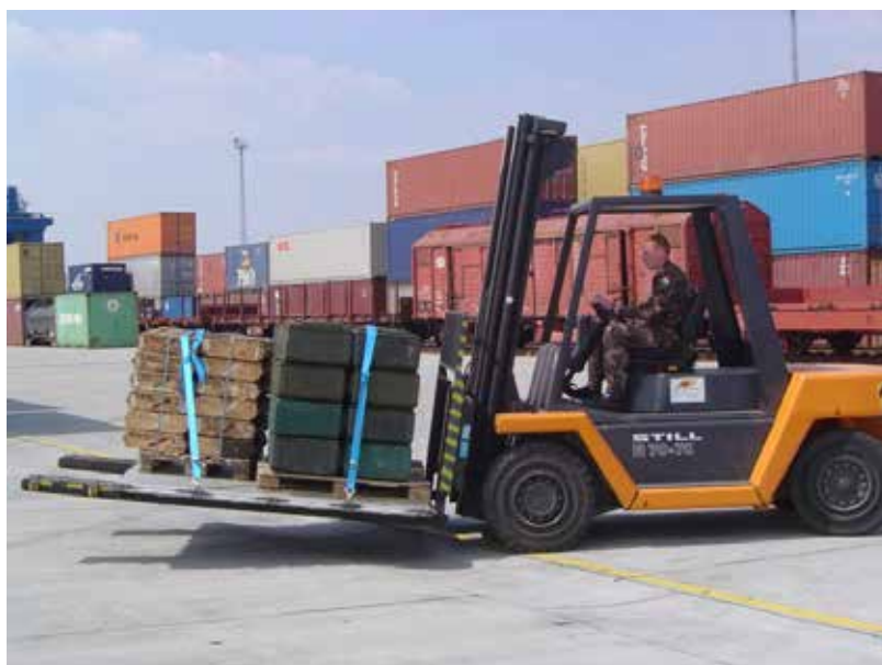
Lőszer rakodás 7 tonnás teherbírású villahosszabbítóval ellátott kerekes targoncával
