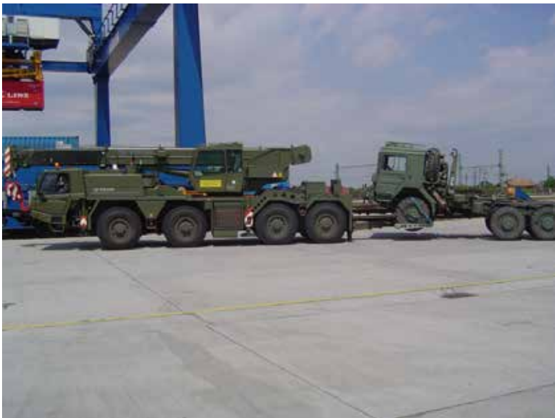
Gépkocsidarú alkalmazása sérült gépjármű vontatására
