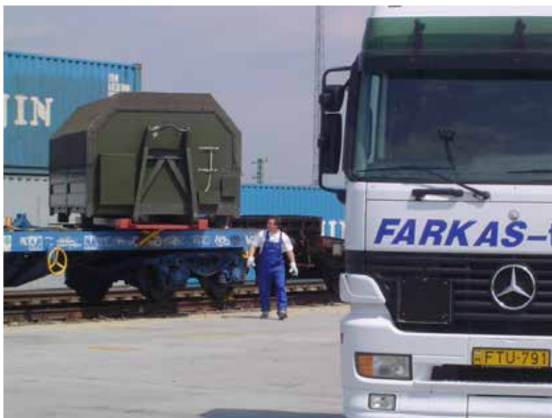
Konténer rakodása tehergépkocsiról – vasúti kocsira kifordítható rakodókerettel (ACTS rendszer)
