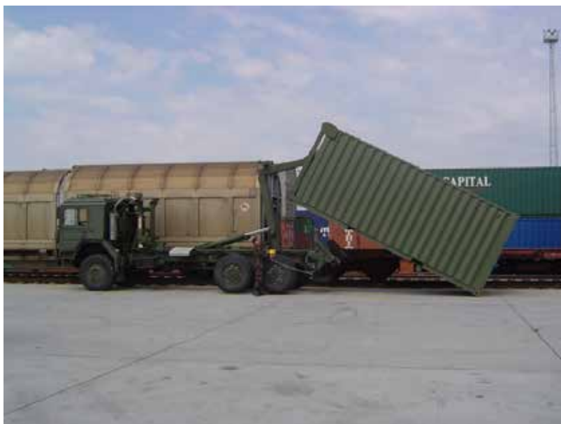
Hidraulikus cserefelépítmény 20 tonnás konténerforgató „H” kerettel
