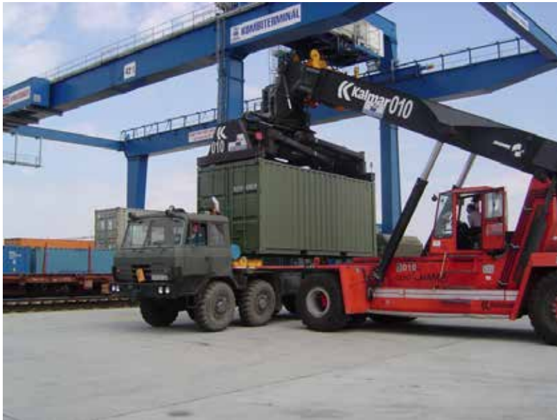
20 tonnás és 40 tonnás konténer emelésére alkalmas targonca.
