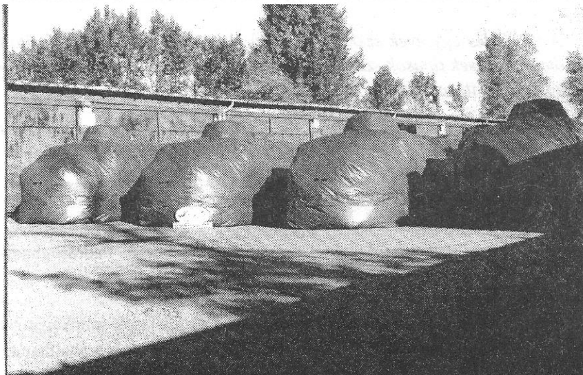
A hosszú időtartamú tárolásba helyezett BTR 80 típusú kerekcs harcjárművek. (Az Alföldi Kiképző Központ telephelyén).
