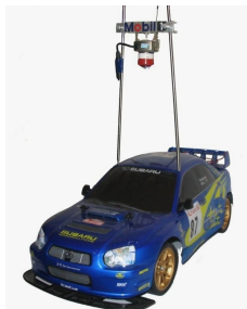
5. ábra. Modellautóból átalakított robot PAL-optikával: PALCOM
