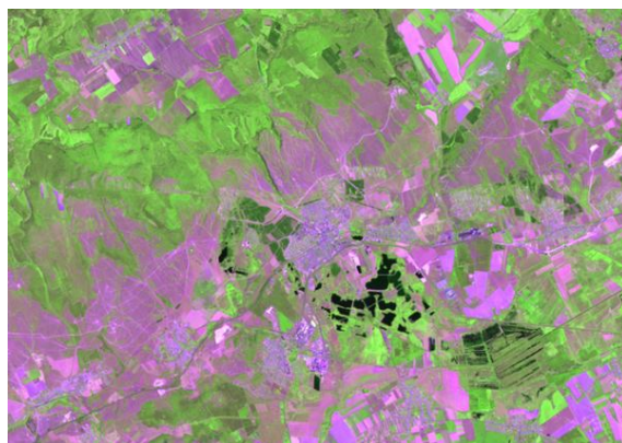
5-4-7 sávokból előállított hamisszínes kép
