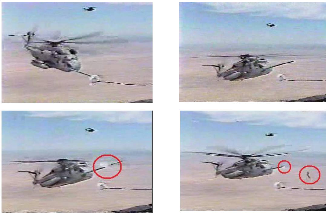
4. kép: Tipikus repülés-technikai hiba helikopterrel végrehajtott légi utántöltés során
