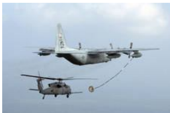
3. ábra Black Hawk helikopter légi utántöltése kosaras módszerrel
