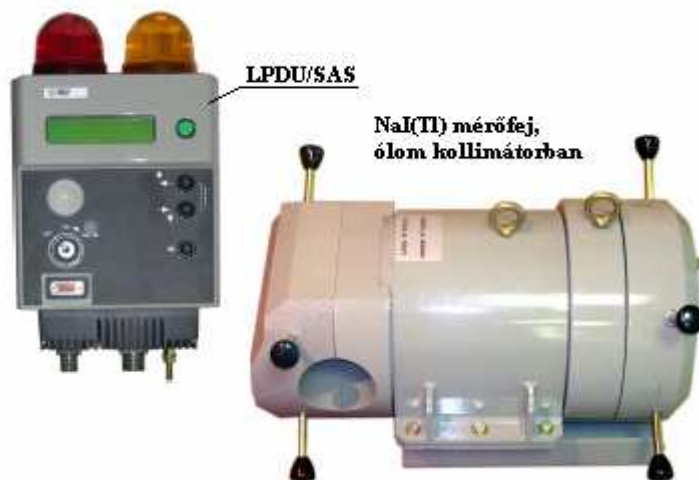
2. ábra NGM 206-L folyadékaktivitás mérő
