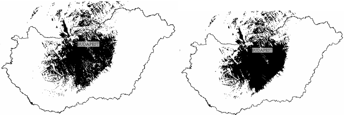
11. ábra Okumura-Hata modell beépítettség figyelembe vételével és anélkül
