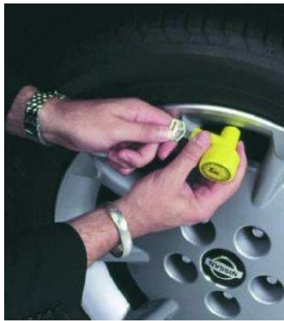
10. ábra. A szelepőr részei és felhelyezése [13]
