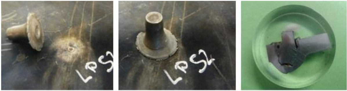
10. ábra. Gombásodott LPSZ lövedékek
