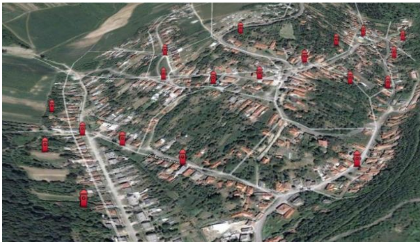
3. ábra. GPS segítségével felmért települési tűzcsap hálózat grafikus megjelenítéssel
