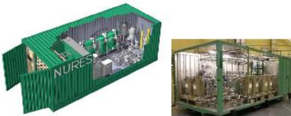
4. ábra. A NURES konténeres mobil víztisztító [4]
