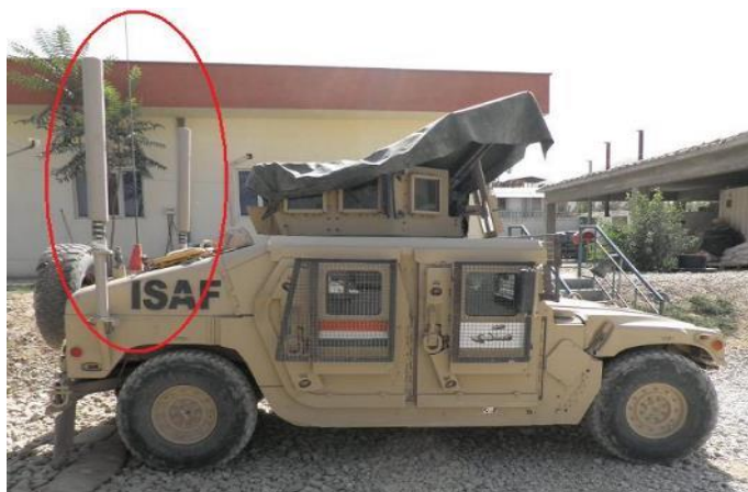
3. ábra. Magyar jelzésű HMMWV zavaróeszközének antennái az MH PRT táborában [8]
