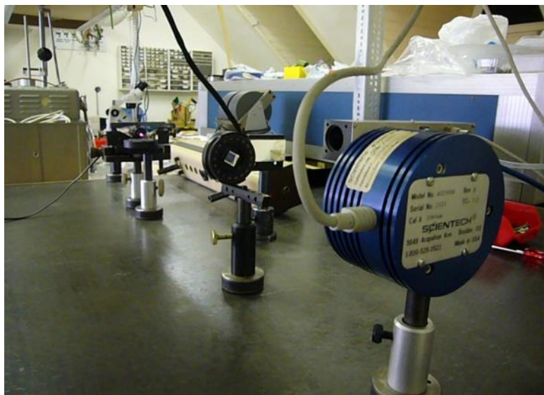
7. ábra. A méréshez használt teljesítménymérő, polarizációs nyalábosztó és a 780 nm-es lézermódul kísérleti elrendezése [10]
