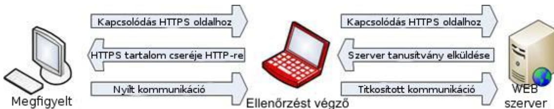
4. ábra. Példa HTTPS kommunikáció ellenőrzésére. (a szerző szerkesztette a [25] alapján)
