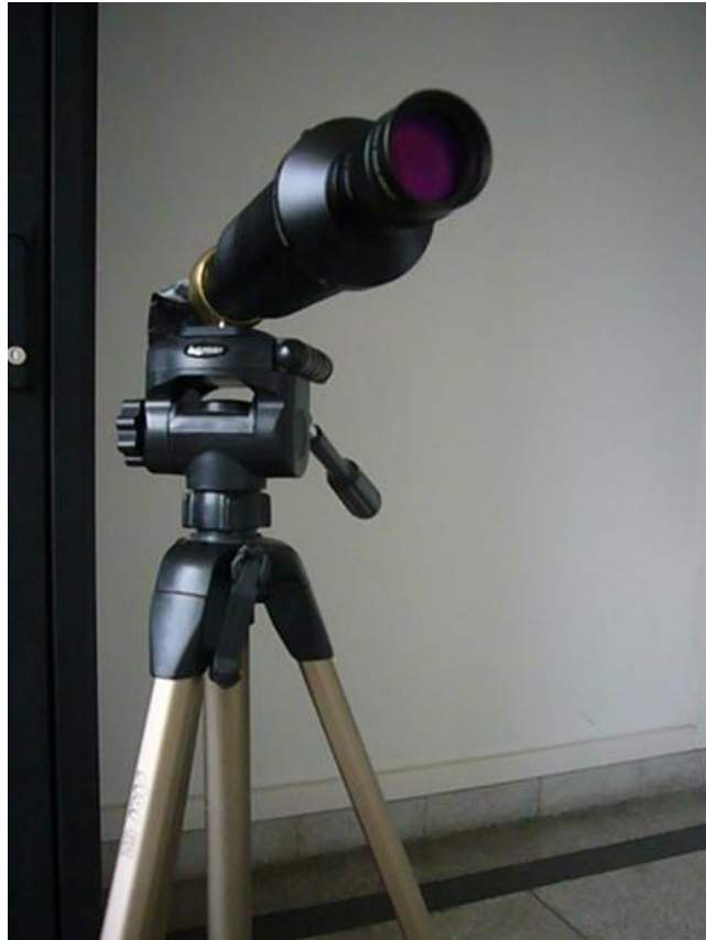
4. kép. A mérésekhez használt 532 nm-es lézer sugárpárhuzamosítóval (beam expander) ellátva (Szerző saját felvétele)
