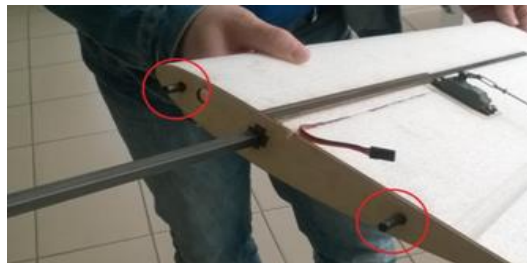
10. ábra. A szárnyvégek kapcsolódása a szárnyközéphez 11
