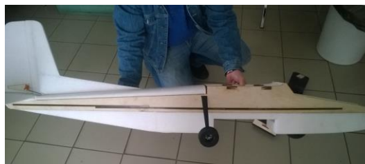
7. ábra. A törzs megerősítése balsa fával és szénszálalás téglalap keresztmetszetű csövekkel 8
