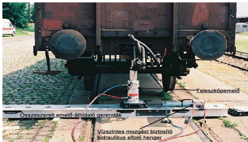
5. kép: Vasúti jármű emelése egy ponton [8]
