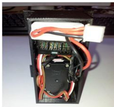
21. ábra. A konténerben elhelyezett szervomotor, vevőmodul és akkumulátor 22
