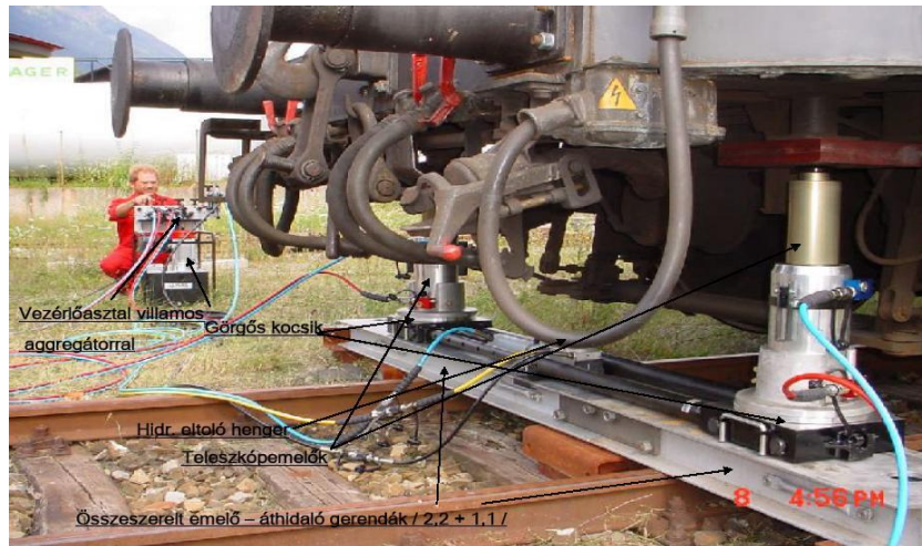
6. kép: Vasúti jármű emelése két ponton [8]
