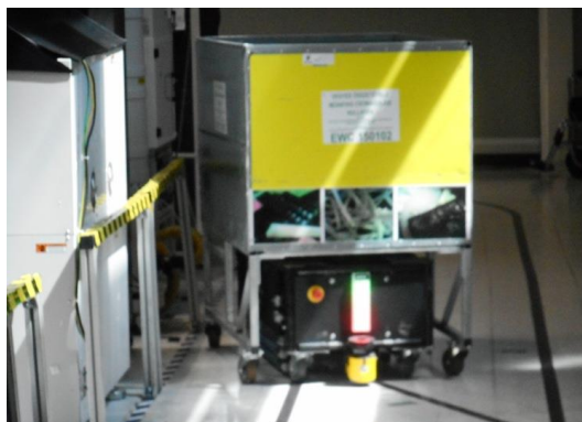
18. ábra: hulladékszállító robot munkában
