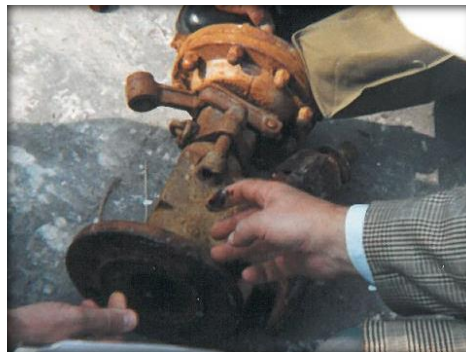
3. kép. A klórkiáramlás megszüntetésére legyártott „kitörés gátló”
