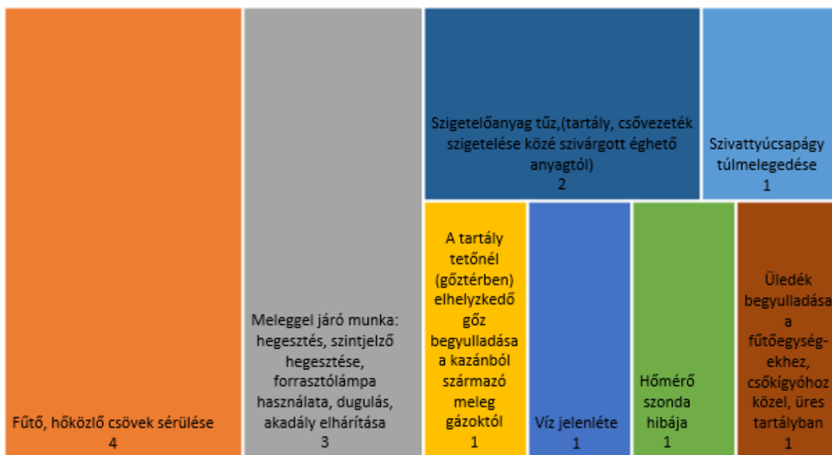
2. grafikon A bitumentároló tartályok jellemző tüzesetei, a természeti eredetű – villám, földrengés – kivételével (a szerző szerkesztése a [16] irodalom alapján)
