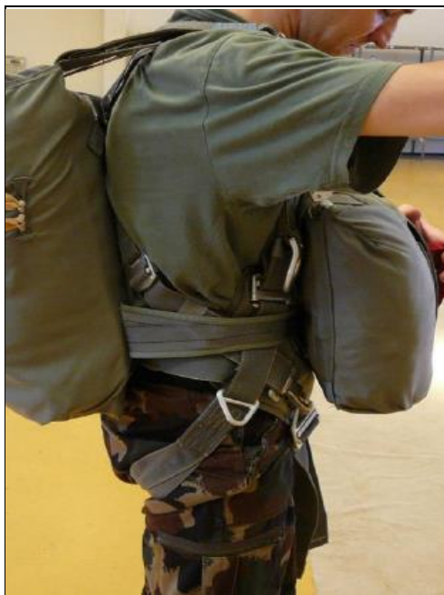
12. kép. Hagyományos elrendezés: hátul az SF-10A típusú kupolájú fő ejtőernyő, elől a T-11R típusú tartalék ejtőernyő. [28]
