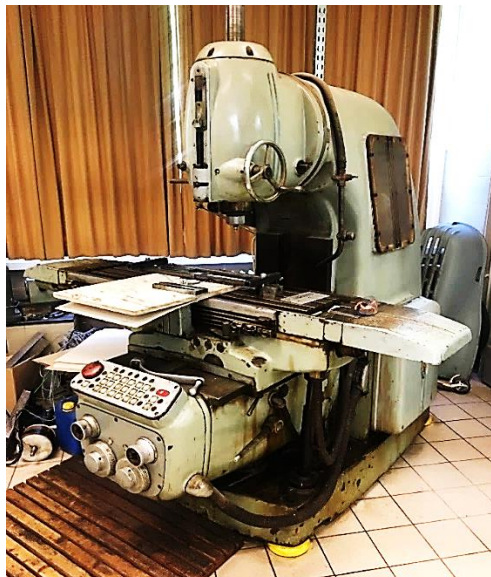
2. ábra. FSW hegesztéshez átalakított MFP 20 típusú marógép
