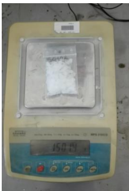
4. ábra. RADWAG WPS 210/C/2 digitális mérleg
