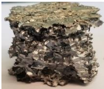
2. ábra: Lyukasztott alumínium hab
