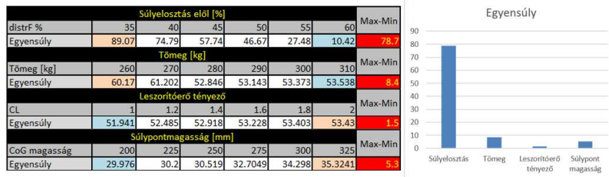
8. ábra. A súlyelosztás, a tömeg, a leszorítóerő tényező és a súlypontmagasság hatása az autó egyensúlyára
