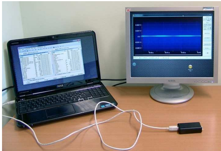
1. ábra. A demo konfiguráció: EDAQ530 és egy laptop (Win7, i7, 4G RAM).
