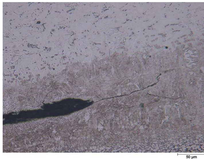
3. ábra: 140 V töltőfeszültséggel készült jó kötés
