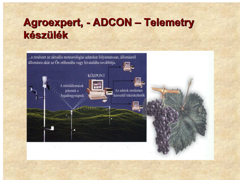
3. ábra: Agroexpert – ADCON – Telemetri készülék működési elve
