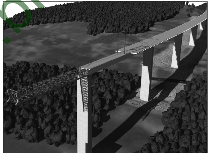
3. ábra: Az acélszerkezet betolása (készült az engedélyezési tervhez)
