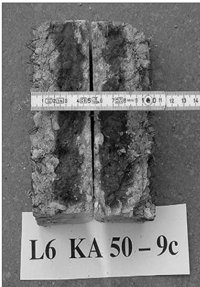
3. fénykép. L6 jelű hámlasztott próbatest (lásd 11. ábra) (megjegyzés: a középső, sötétebb tónusú tartományok fenolftalein pozití- vak)
