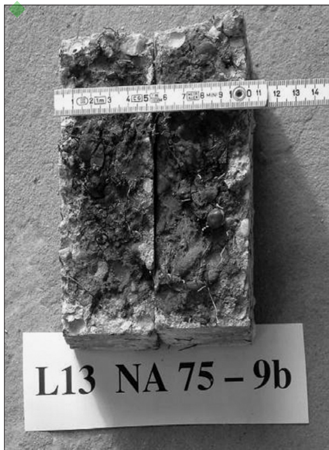
6. fénykép. L13 jelű hámlasztott próbatest (lásd 11. ábra) (megjegyzés: a középső, sötétebb tónusú tartományok fenolftalein pozití- vak)
