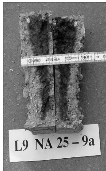
2. fénykép. L9 jelű hámlasztott próbatest (lásd 11. ábra) (megjegyzés: a középső, sötétebb tónusú tartományok fenolftalein pozitívak)
