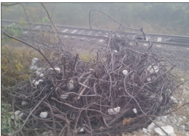
9. ábra: A hídból megmaradt összegyűrt vasak
