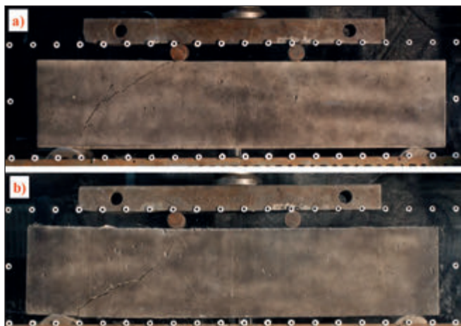
7. ábra: Jellemző tönkremeneteli módok a nyírási teherbírás vizsgálat során, a) nyírási-húzási tönkremenetel az M-0-HL0.5-3 jelű gerenda esetében, b) nyírási-hajlítási tönkremenetel az M-0-CX0.5-3 gerenda esetében
