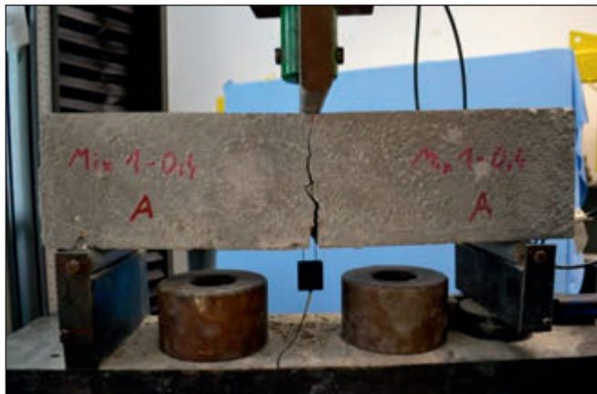
4. ábra: Három pontos hajlító-húzószilárdság vizsgálat CMOD vezérelten
