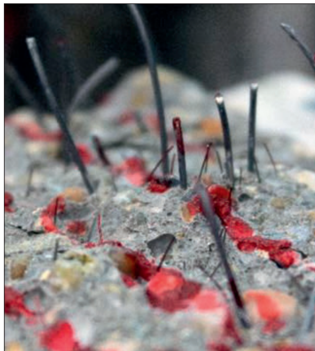
6. ábra: Acélszál erősítésű beton gerenda törési keresztmetszete kétféle acélszál együttes alkalmazása esetén
